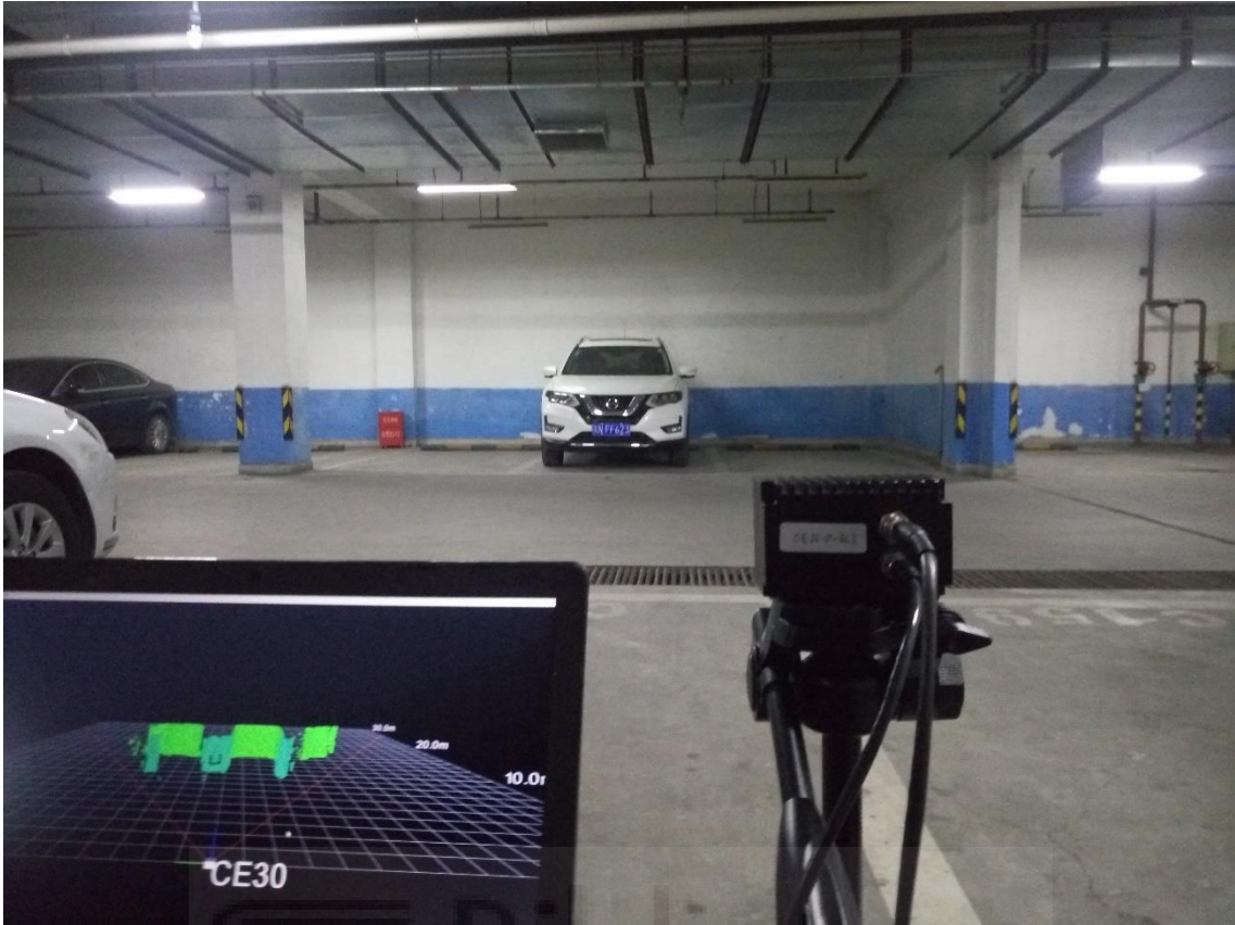
Ilustración 12: Prueba de uso del Lidar de Benewake CE30
