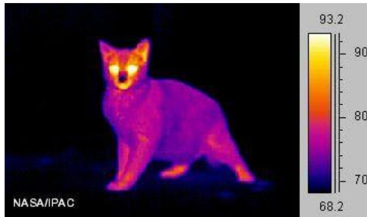
Ilustración 4: Niveles de temperatura detectados en el cuerpo de un animal a través de la medida de la radiación infrarroja que emite
