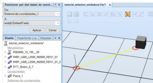
Figura 190: Situar objeto con dos bases de coordenadas
