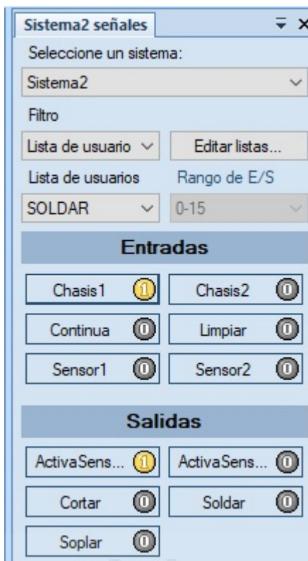
Figura 289: Simulador de las señales de entrada y salida de la estación.
