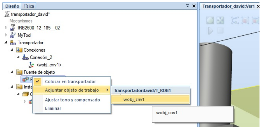
Figura 110: Colocación de la pieza sobre el transportador V.
