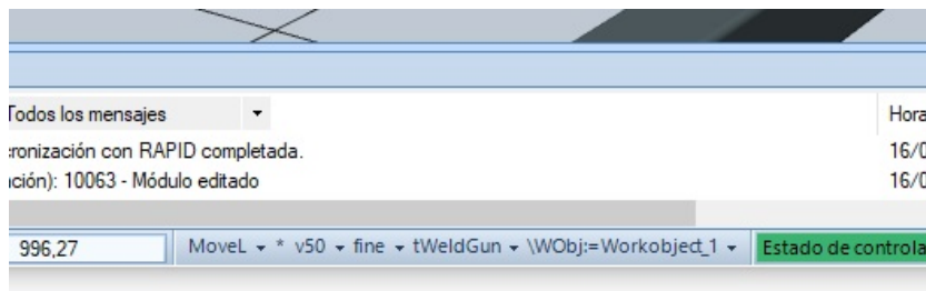
Figura 238: PLantilla de instrucciones de movimiento seleccionada
