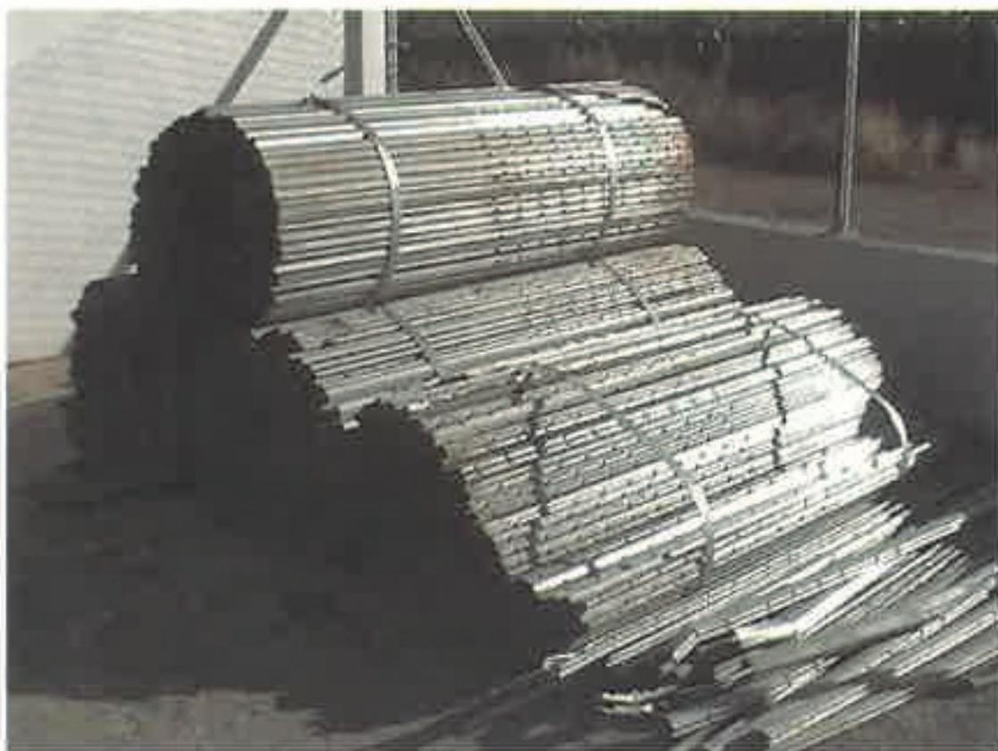
Fotografía n° 12. Postes de acero galvanizado de 2m de longitud y 22 ranuras portaalambre.
