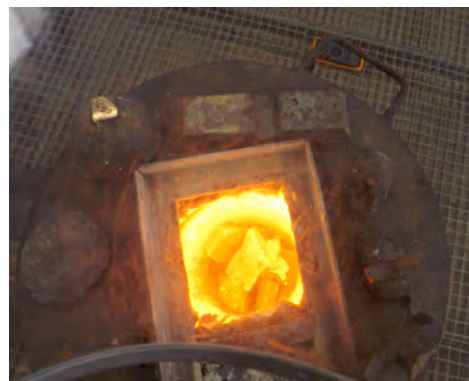
Figs.223, 224: Detalle de la apertura superior del horno para el control del caldo.
