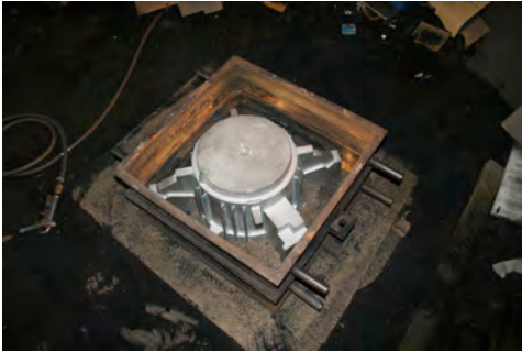
Figs.551, 552: Introducción del modelo en el encofrado, y vertido de la arena resinada.
