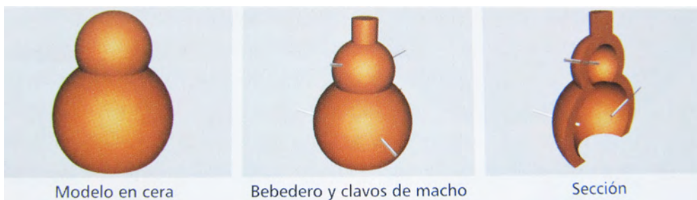
Fig.116: Esquema de montaje de clavos de macho para cascarilla cerámica.
