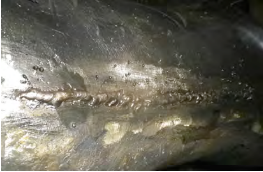
Fig.675, 676: Detalle de la soldadura de las dos mitades, y pieza ensamblada y retocada.
