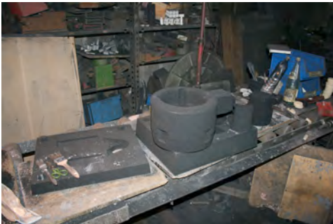
Fig.555: Núcleo o macho de arena.
