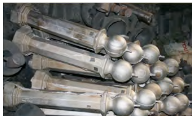
Figs.561,562: Proceso de limpieza de los restos de arena de los modelos. Fig.563: Piezas limpias de arena listas para retoque.
