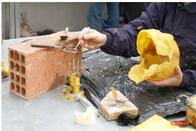
Fig.77: Trabajo de la cera con herramienta calentada con mechero Bunsen.
