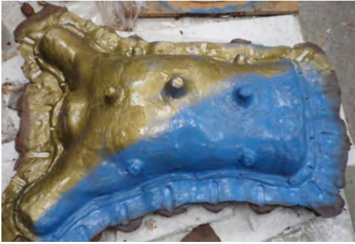
Fig.622: Señuelo de barro pintado para aislar la humedad.
