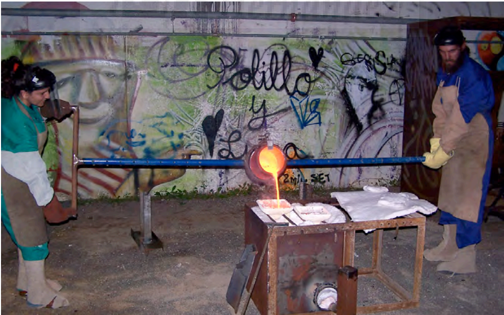
Fig.323: Colada de las primeras piezas en bronce fundidas en Altea, con cascarilla cerámica.
