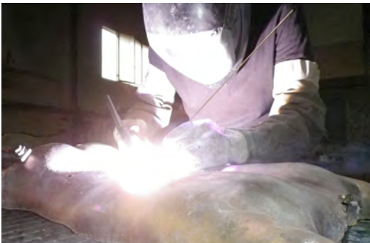
Fig.673, 674: Soldadura de los agujeros de los clavos de macho con sodador T.I.G.
