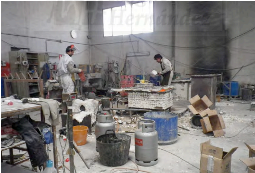
Fig. 699: Vista general de la zona de colada; en ella aparecen a la izquierda Pedro Mendoza, mano derecha de Jaume Espí en la empresa, y a la derecha, Jaume Espí preparando el caldo para verter en los moldes que se encuentran en el cubículo blanco que vemos delante de él, calentándose para estar atemperados en el momento de la vertida del metal fundido.
