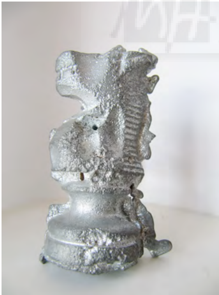
Fig.53: Pieza realizada a la arena con modelo perdido.
