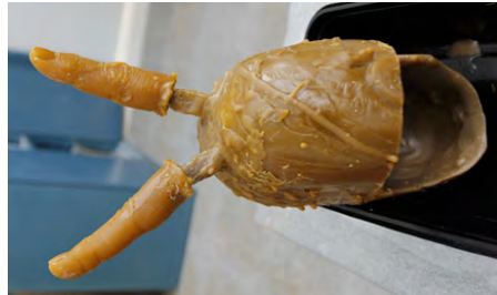
Figs.139, 140, 141, 142: Ejemplos de árboles de colada para microfusión por volteo.
