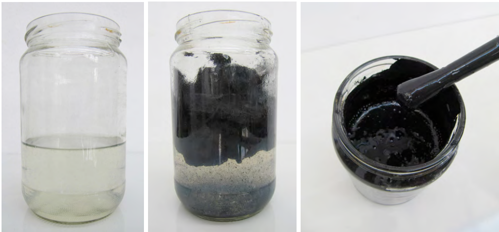
Figs. 167, 168, 169: Mezcla de grafito y sílice coloidal.
