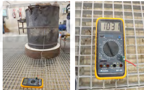
Figs.221, 222: Situación del pirómetro y detalle.
