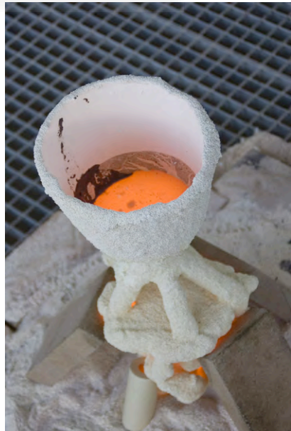
Figs. 246, 247: Detalle del horno para colada por crisol fusible encendido y pieza recién fundida.
