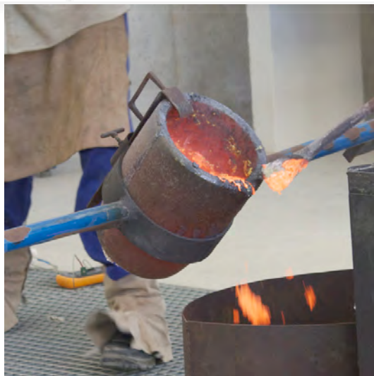
Fig.229: Detalle del proceso de escoriado.
