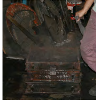
Figs.551, 552: Introducción del modelo en el encofrado, y vertido de la arena resinada.
