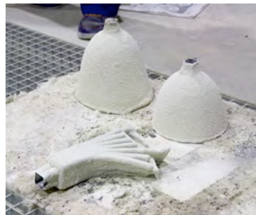
Fig.200: Fragmentos de moldes de crisol fusible descerados.
