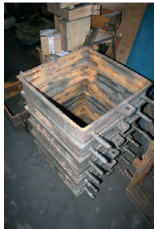
Fig.550: Encofrados para moldes de arena.
