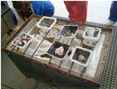
Fig.209: Distribución de las cascarillas en el lecho de colada.
