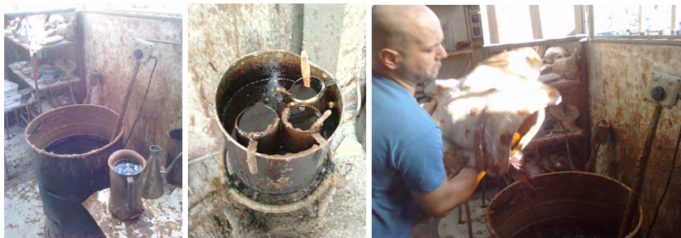
Figs.688 - 690: Bidones con la cera apunto para verter en los moldes. Vemos en la figura de la derecha a un operario realizando una capa de cera por vertido a un molde de silicona, fragmento de una obra monumental de Jaume Espí.
