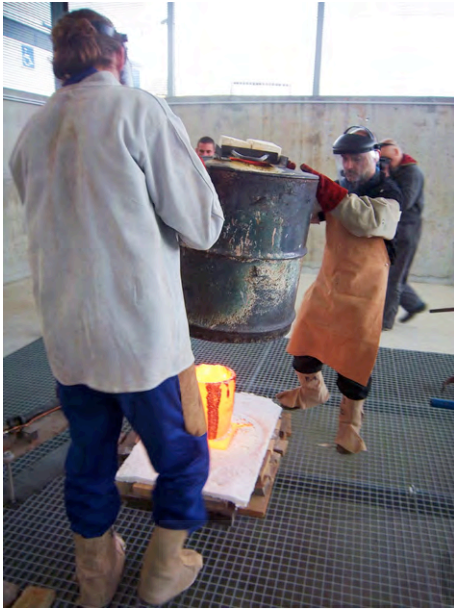
Figs.225, 226: Imágenes de la retirada de la campana del horno.
