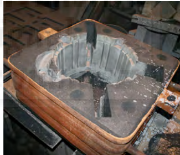
Fig.553, 554: Extracción del modelo de la caja de arena y vista del molde.
