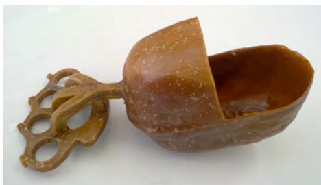
fig.138: Sistema de colada terminado.
