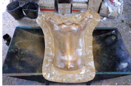
Fig.644: Primera mitad del molde preparado para su reproducción en cera.
