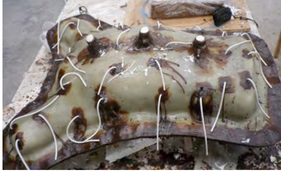
Fig.640: Eliminación de entradas y respiraderos una vez ha fraguado la silicona.
