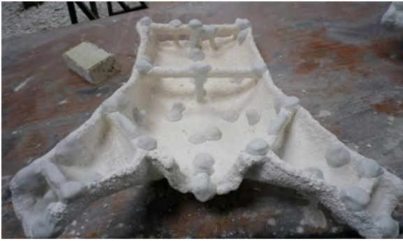
Figs.660, 661: Vista del molde refractario una vez tapados los orificios con pasta de moloquita y manta cerámica.
