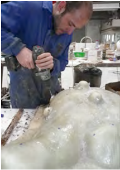
Fig.635: Perforación de la carcasa para la realización de respiraderos y entradas.
