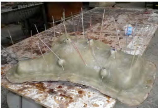
Fig.637: Incorporación de respiraderos y de tornillos de anclaje.
