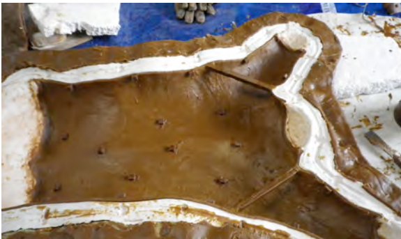
Fig.646: Capa de cera terminada, ensamblado de puntos de sujeción y refuerzos.
