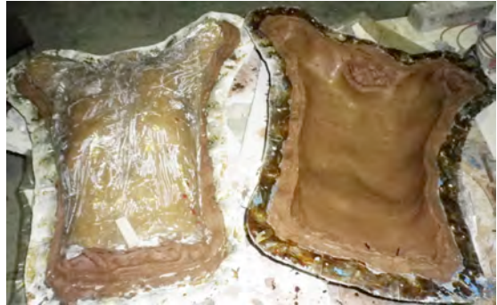
Fig.631: Apertura de las carcasas con ayuda de cuñas de madera. Fig.632: Ambas carcasas separadas para iniciar el trabajo con la silicona, el modelo queda fijado en una de las partes.
