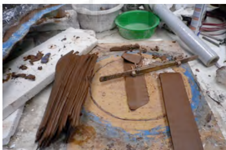
Fig.617: Cortador de barro ara la realización de secciones uniformes.
