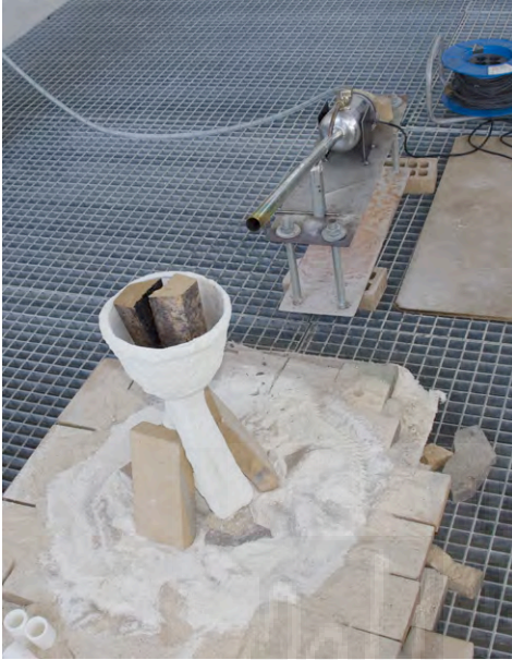
Figs. 244, 245: Detalle de la posición del molde para colada por crisol fusible, quemador turbo asistido, y campana del horno.
