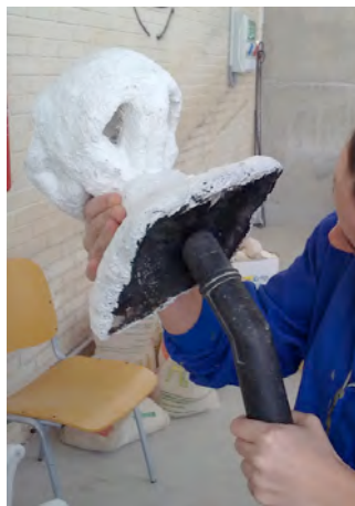
Fig. 208: Aspirado del interior del molde.
