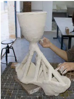
Figs. 205, 206: Ensamblado de las copas y los sistemas de riego para crisol fusible.
