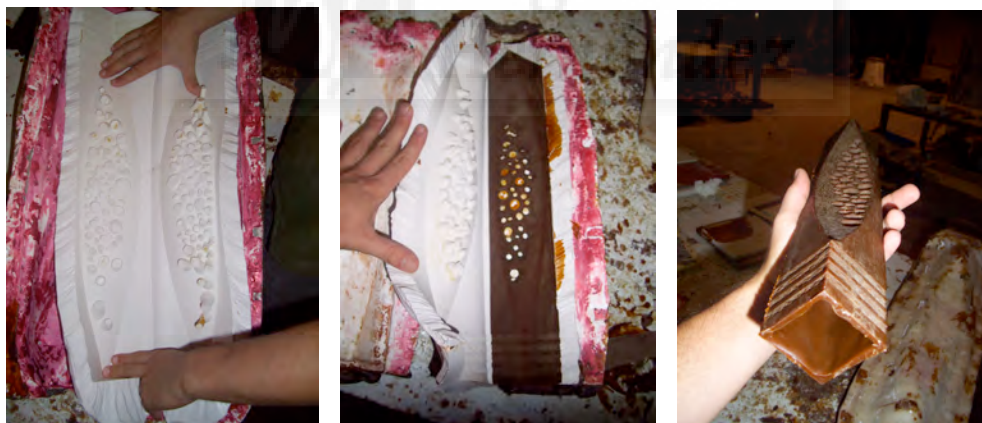
Figs.691 - 693: Imágenes de positivado de una de las piezas de Jaume Espí; en la Fig.691 el molde de silicona abierto, aún vacío; en la Fig.692 el molde abierto después del proceso de bañado con la cera y en la Fig.693 la pieza en cera lista para ser montada en el árbol de fundición correspondiente.
