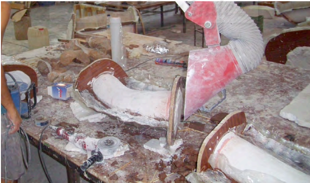
Fig.686: Zona de moldes y detalle de la mesa de recorte de las carcasas de fibra de vidrio y resina de poliéster, con extracción localizada para la eliminación de las partículas desprendidas durante estos procesos.
