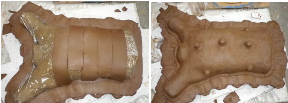
Fig.620: Disposición de las lonchas de barro sobre el modelo para la realización del señuelo.
