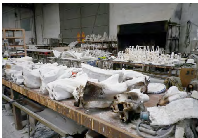
Figs.697,698: Imágenes de la zona de descere; en la Fig.697 vista de la campana de descere, y las mesas de refuerzo al frente. En la Fig.698 observamos una vista general de la zona, con las mesas de sellado de las cascarilla después del descere.
