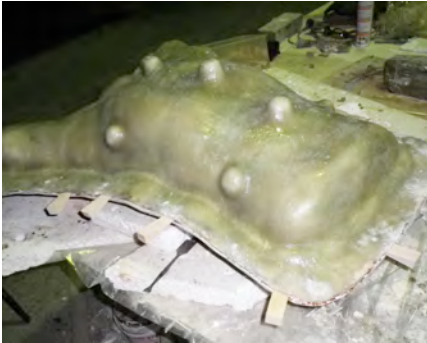
Fig.631: Apertura de las carcasas con ayuda de cuñas de madera. Fig.632: Ambas carcasas separadas para iniciar el trabajo con la silicona, el modelo queda fijado en una de las partes.
