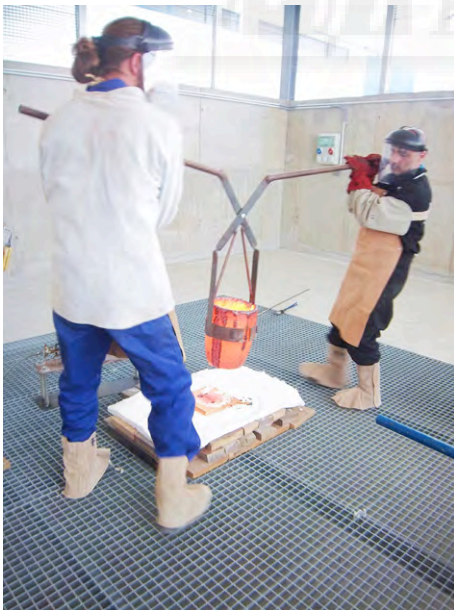
Figs.227, 228: Extracción del crisol y apoyo en el maneral.
