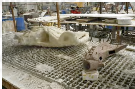
Fig.602: Modelo en cera con el árbol de fundición montado. Fig.603: Fragmentos de la obra en fase de realización del molde refractario.
