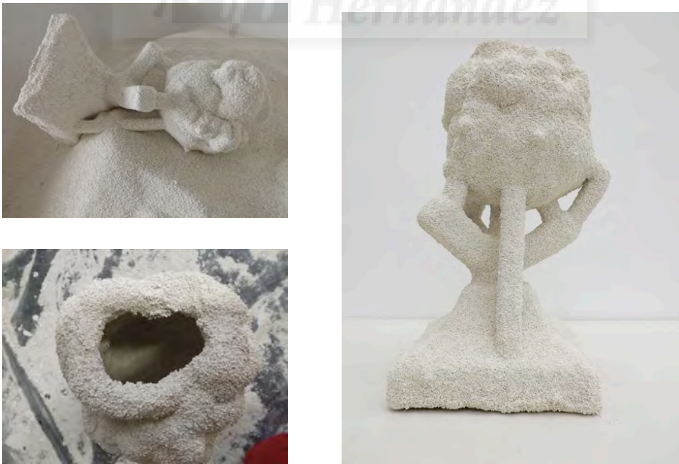
Figs.180, 181, 182: Molde refractario con todos los baños dados.
