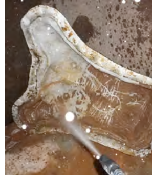
Fig.633: Preparación del modelo para verter la silicona; eliminación del plástico y ajuste del borde de unión de las membranas.
