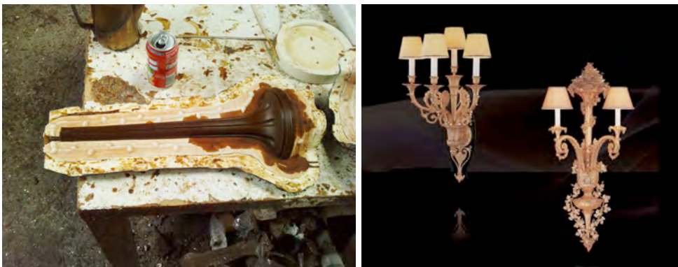
Figs. 711, 712: Imágenes del producto de Jaume Espí para Mariner: en la figura de la izquierda vemos un fragmento de la lámpara en cera, en la figura de la derecha vemos la lámpara terminada.
