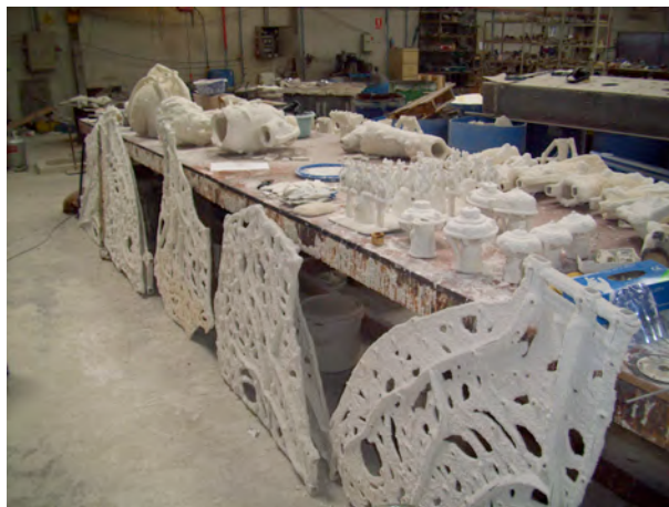
Fig.680: Vista de la mesa de terminación de los moldes cerámicos, con elementos de todo tipo realizados con cascarilla cerámica: desde pequeñas piezas de industria, hasta grandes fragmentos de escultura monumental.
