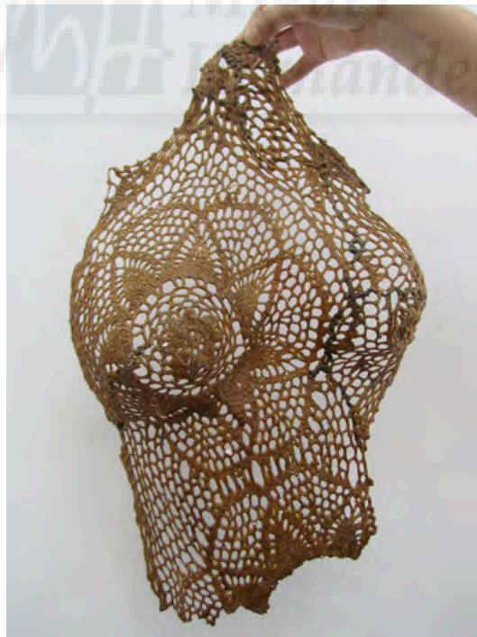
Fig. 104: Modelo para fundición realizado con hilo de algodón bañado en cera.
