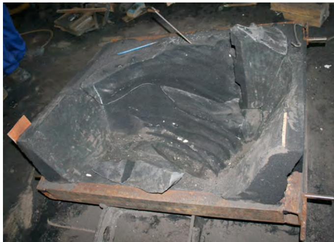
Fig.558: Fragmento del molde de arena para la reproducción del modelo de la fig.527.
