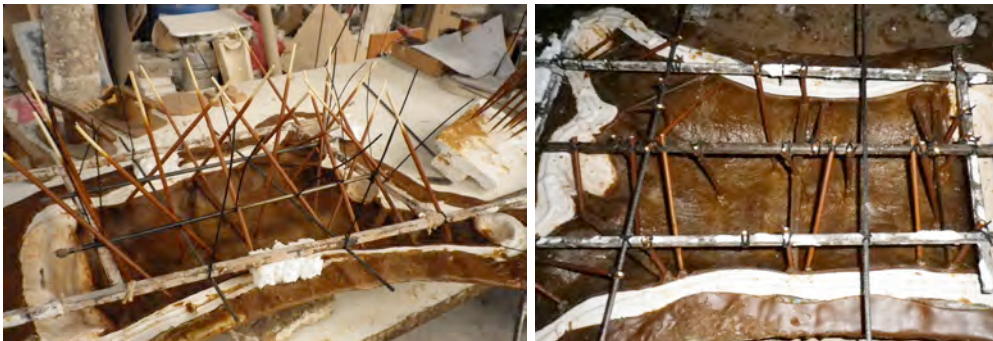
Fig.648: Anclaje de la estructura exterior al modelo mediante palillos encerados.
