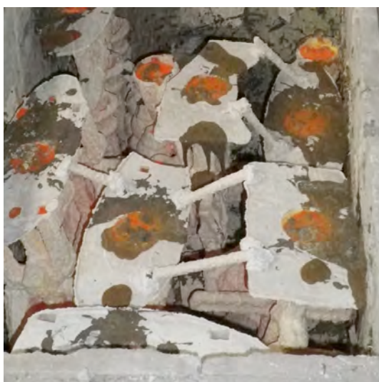
Fig.701: Vista de los moldes refractarios una vez rellenos de metal fundido, en proceso de enfriamiento.
