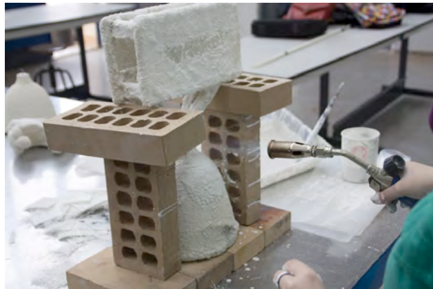
Figs. 205, 206: Ensamblado de las copas y los sistemas de riego para crisol fusible.
