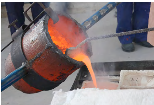
Fig.230: Vertido de caldo en uno de los moldes de cascarilla cerámica.
