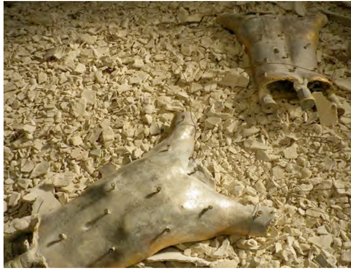
Fig.669: Extracción de las piezas del lecho de colada.
