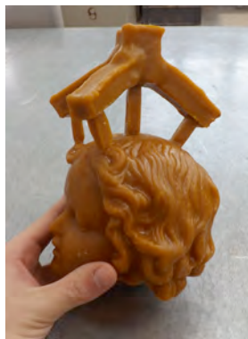
Fig.126 Montaje del bebedero principal.
