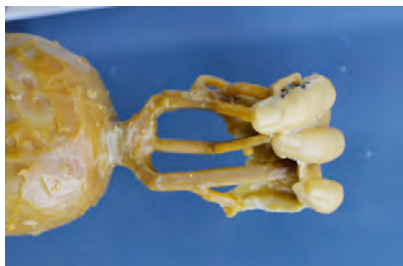
Figs.139, 140, 141, 142: Ejemplos de árboles de colada para microfusión por volteo.
