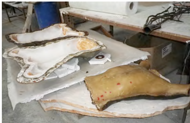
Fig.643: Molde bivalvo de membrana flexible de silicona con carcasa de resina de poliéster finalizado.
