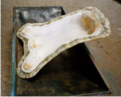
Fig.644: Primera mitad del molde preparado para su reproducción en cera.
