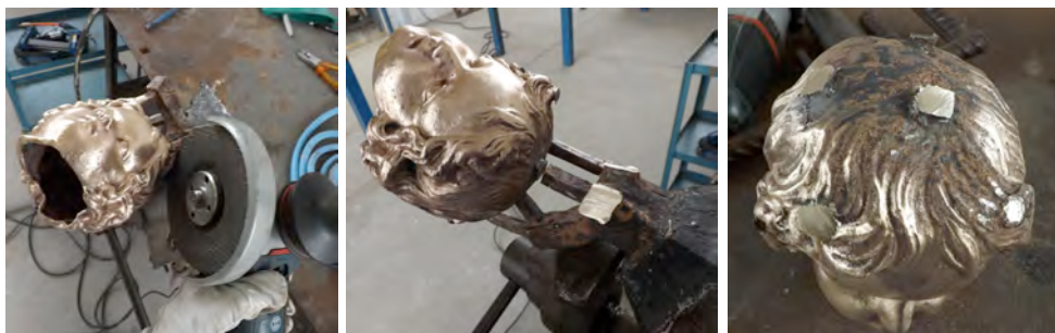
Figs. 254, 255, 256: Recorte del metal sobrante procedente del sistema de riego.
