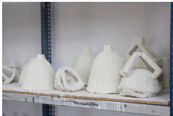
Figs.187, 188, 189: Secado de moldes para crisol fusible.
