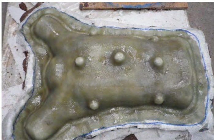
Fig.626: Carcasa o "madre" de resina de poliéster y fibra de vidrio concluida.
