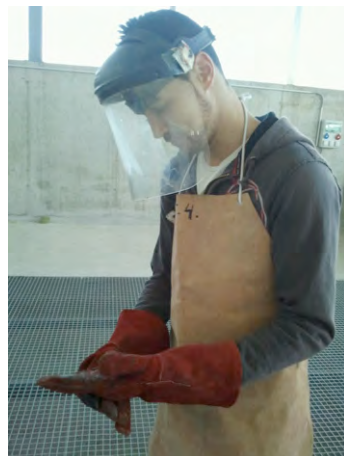
Fig.193: Equipos de protección para el descere.
