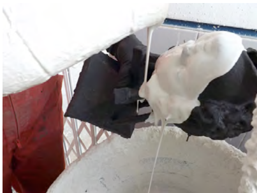
Fig.173: Aplicación del primer baño de papilla.
