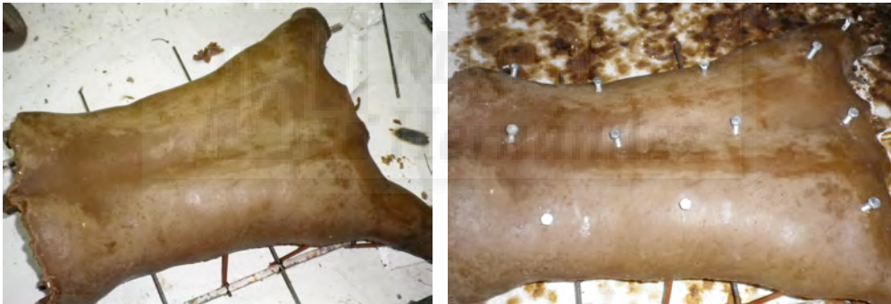
Fig.650: Modelo preparado para dar comienzo a la creación del molde refractario.
