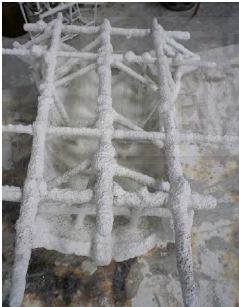
Fig.656: Vista trasera de una de las partes del molde refractario concluido.
