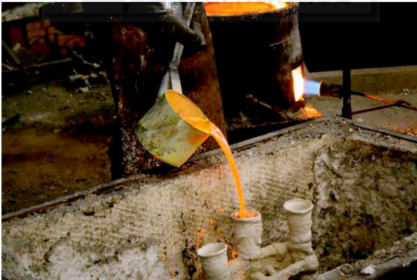
Fig.668: Detalle de la entrada del caldo en el molde refractario.
