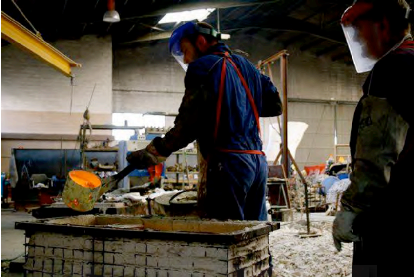
Fig.667: Colada realizada a cucharadas.
