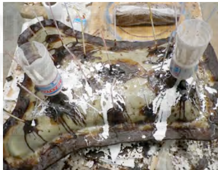
Fig.641: Preparación de la segunda carcasa para el vertido de la silicona.
