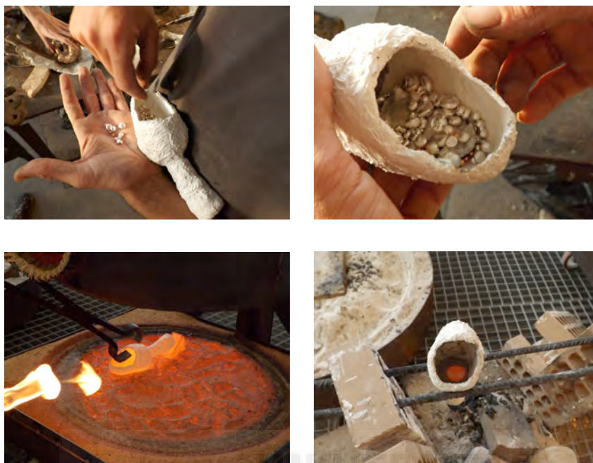
Figs.351-354: Imágenes de la realización de aleación de plata de ley para la fundición de anillos.
