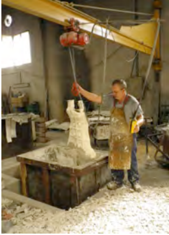
Fig.669: Extracción de las piezas del lecho de colada.
