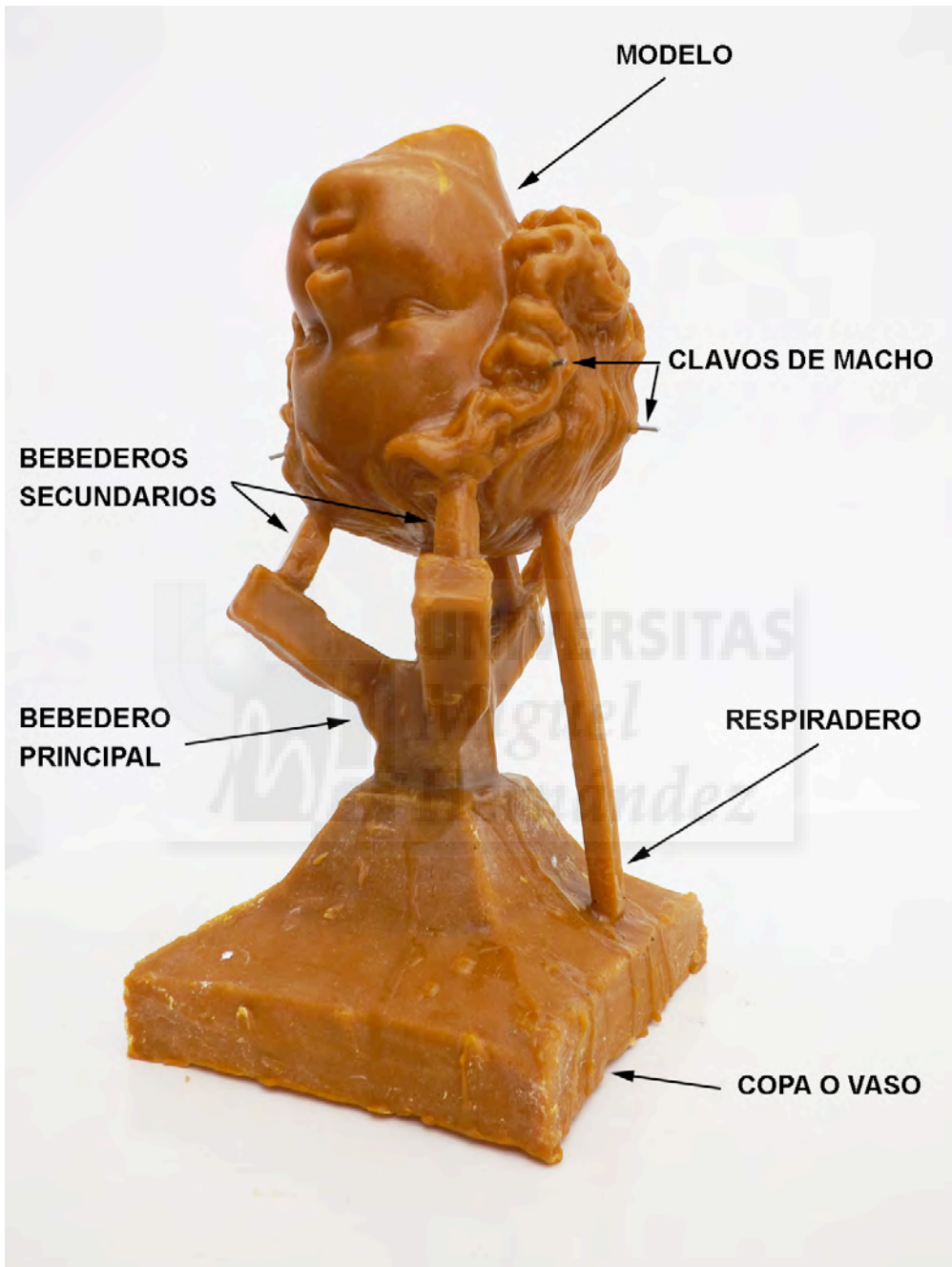
Fig.115: Esquema tipo de árbol de colada para fundición con cascarilla cerámica.
