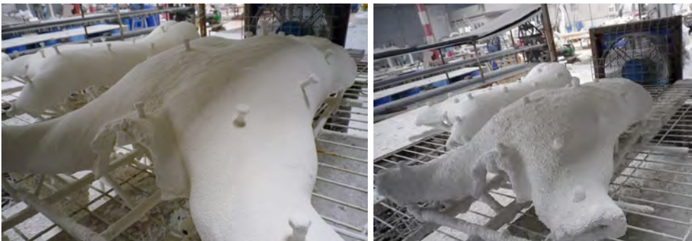
Fig.654: Segunda capa de refractario, papilla y estucado de moloquita de grano fino. Fig.655: Proceso de baños y estucado concluido con un total de cinco capas.
