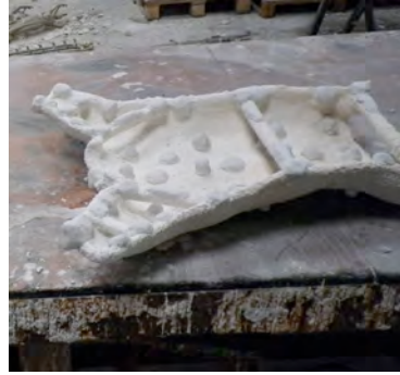
Figs.660, 661: Vista del molde refractario una vez tapados los orificios con pasta de moloquita y manta cerámica.
