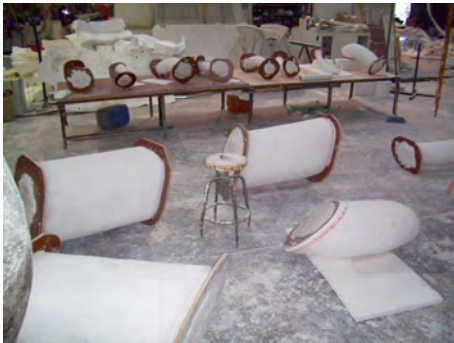
Fig.684, 685: Zona de moldes y detalle de la realización de la carcasa de resina de poliéster para un fragmento de la obra monumental "Savia".
