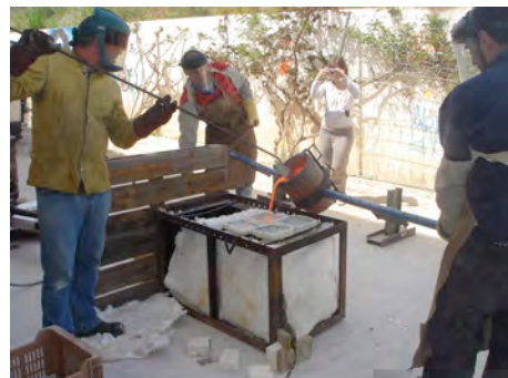
Figs.299, 300: Situación de los elementos y preparación de una colada exterior.
