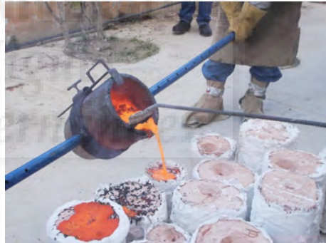
Fig.276: Colada en moldes de chamota.
