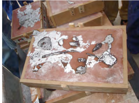
Fig.274: Piezas fundidas a la arena.
