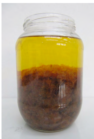
Figs. 162,163,164: Proceso de disolución de las escamas de goma-laca en alcohol.
