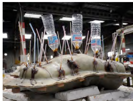
Fig.638: Molde preparado para el vertido de la silicona que formara la primera membrana.
