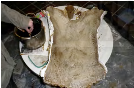
Fig.611: Realización del positivo en cera: engorde de la capa a pincel. Fig.612: Ensamblado de las dos partes que componen el modelo.
