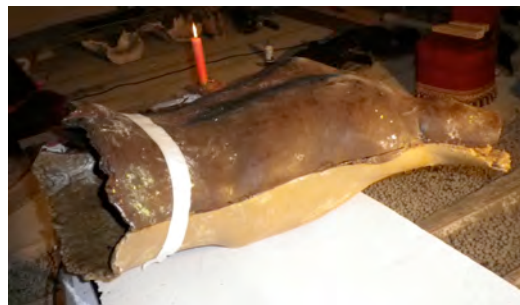
Fig.611: Realización del positivo en cera: engorde de la capa a pincel. Fig.612: Ensamblado de las dos partes que componen el modelo.
