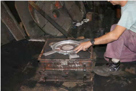
Fig.553, 554: Extracción del modelo de la caja de arena y vista del molde.
