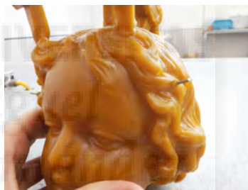
Fig.128: Detalle de posición de clavos de macho.
