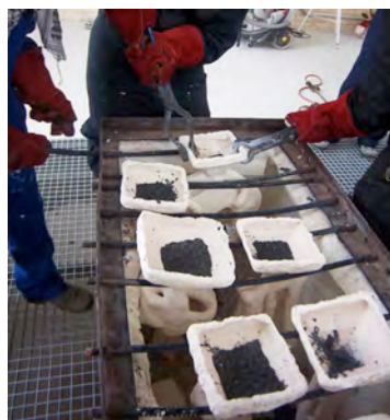
Fig.235: Retirada de las piezas del lecho de colada.
