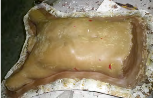
Fig.633: Preparación del modelo para verter la silicona; eliminación del plástico y ajuste del borde de unión de las membranas.
