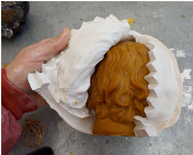
Fig.102: Extracción del modelo de cera de un molde de silicona.
