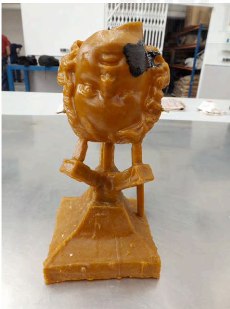
Figs. 170, 171: Aplicación de la capa de grafito.
