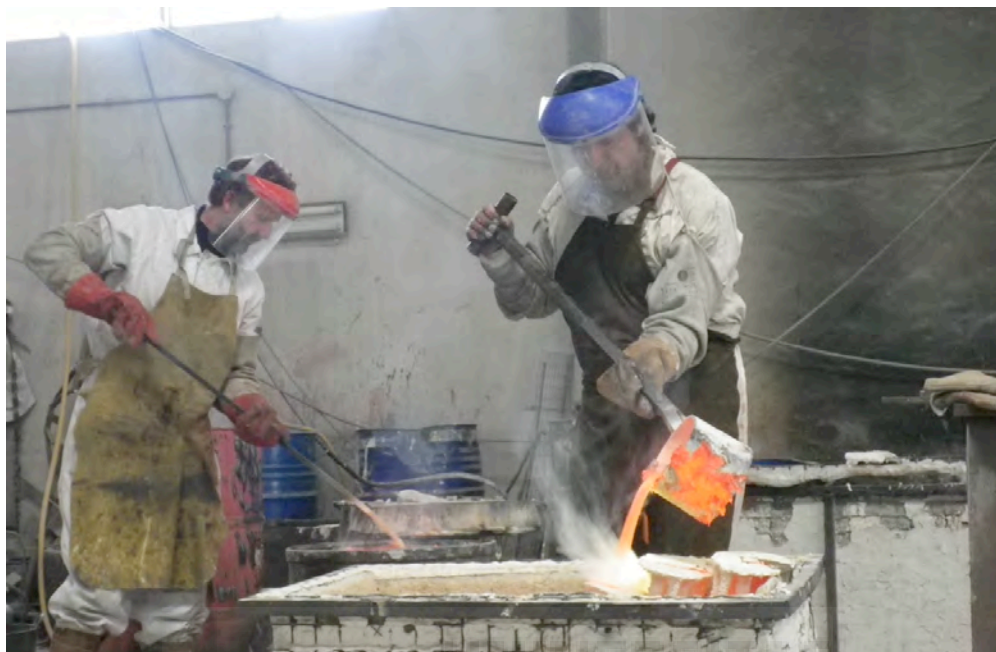
Fig.700: Proceso de vertido del metal en los moldes: Jaume Espí realizando el vertido del caldo "a cucharadas", esto simplifica la técnica ya que elimina la manipulación del crisol en su totalidad, y permite la realización de la colada en solitario. A la izquierda de la imagen, Pere Mendoza, operario de la empresa y mano derecha de Jaume Espí, elimina la escoria que queda en la superficie del caldo para limpiarlo y que el fundidor pueda recogerlo libre de impurezas.
