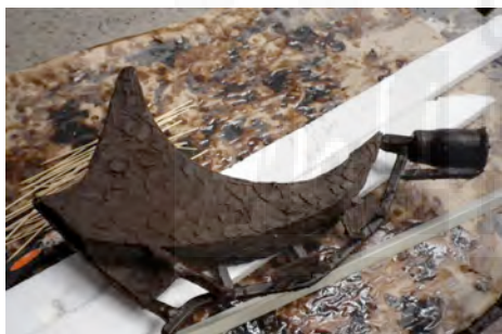
Fig.602: Modelo en cera con el árbol de fundición montado. Fig.603: Fragmentos de la obra en fase de realización del molde refractario.
