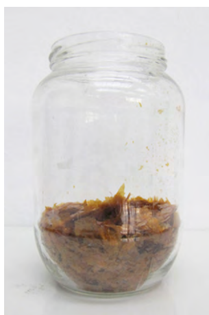
Figs. 162,163,164: Proceso de disolución de las escamas de goma-laca en alcohol.
