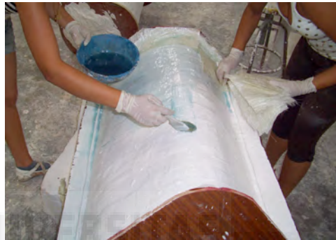
Fig.684, 685: Zona de moldes y detalle de la realización de la carcasa de resina de poliéster para un fragmento de la obra monumental "Savia".
