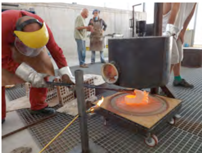
Figs.349, 350: Imágenes de coladas por volteo con dos cascarillas dentro del nuevo horno para microfusión.
