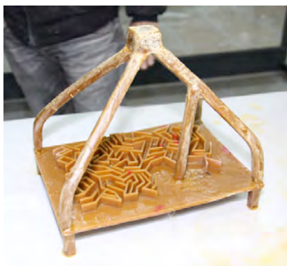
Fig.143: Árbol de colada crisol fusible.
