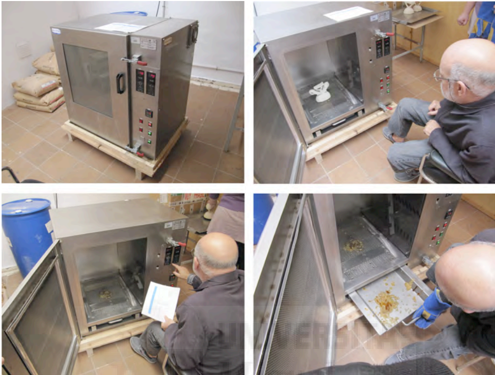
Figs. 818, 819: Imágenes del prototipo de microondas para descere desarrollado por Juan Carlos Albaladejo.
