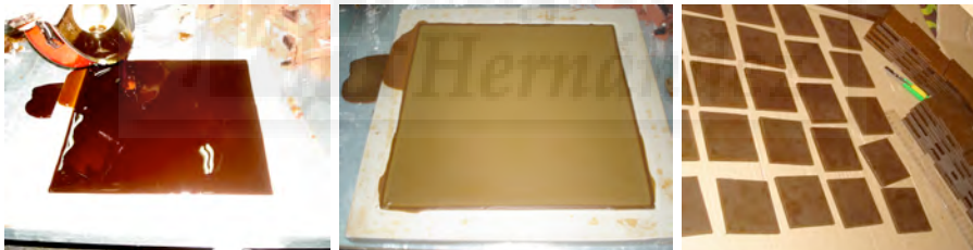
Figs.78, 79, 80: Proceso de elaboración de planchas de cera.
