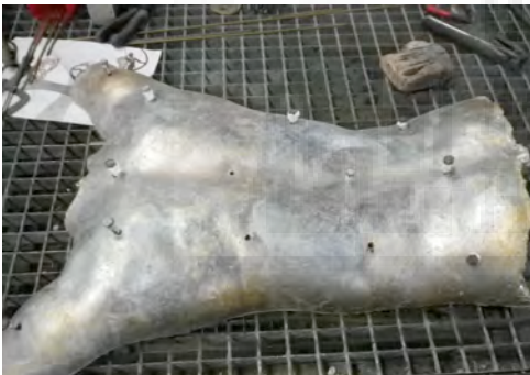
Fig.671, 672: Detalle de los clavos de macho y su extracción.
