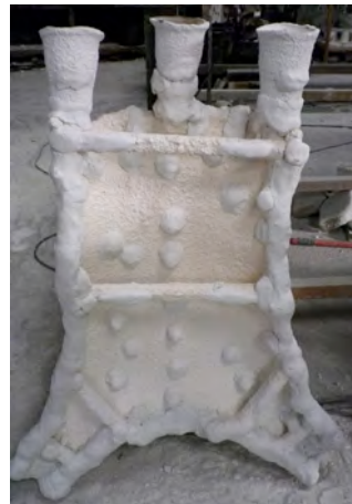
Fig.664: Detalle de los refuerzos de alambre recubiertos con pasta de moloquita. Fig.665: Molde refractario con los vasos ya ensamblados.
