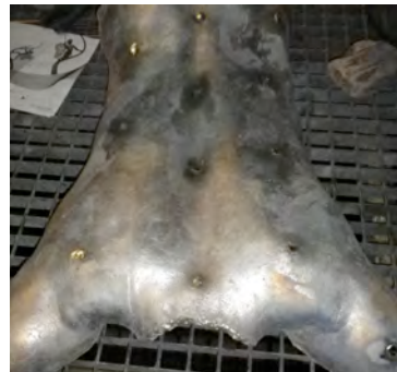
Fig.673, 674: Soldadura de los agujeros de los clavos de macho con sodador T.I.G.
