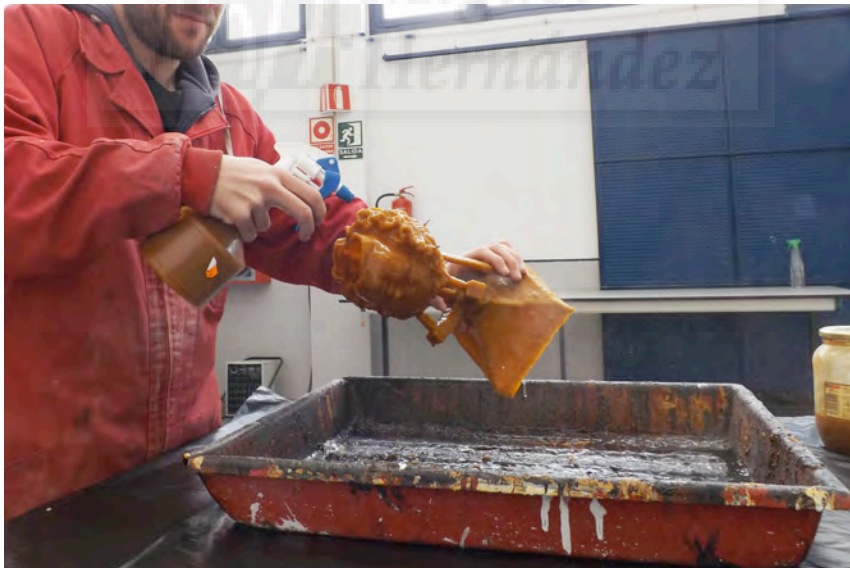
Fig.165: Aplicación de goma-laca al modelo, con la ayuda de un pulverizador.
