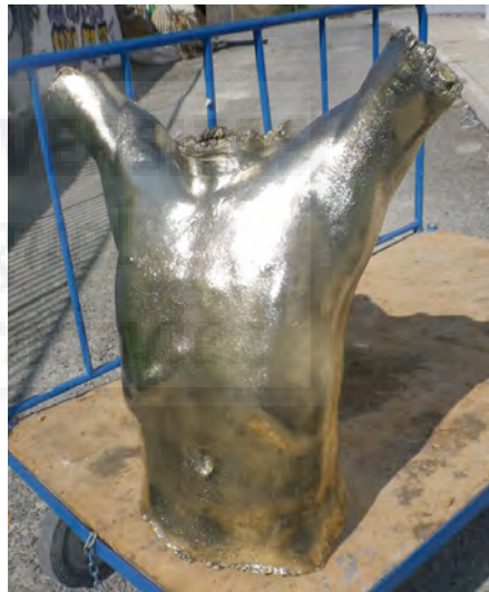
Fig.677: Detalle del acabado pulido mediante portea y disco de trapo aplicado con taladro.
