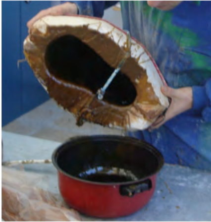
Figs.93, 94: Realización de la capa de cera mediante baños.
