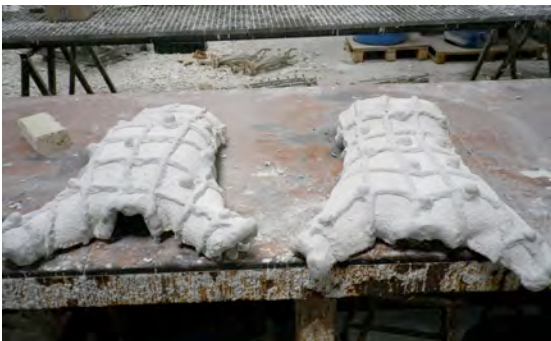
Fig.664: Detalle de los refuerzos de alambre recubiertos con pasta de moloquita. Fig.665: Molde refractario con los vasos ya ensamblados.
