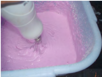
Fig.96: Mezcla del alginato con batidora.
