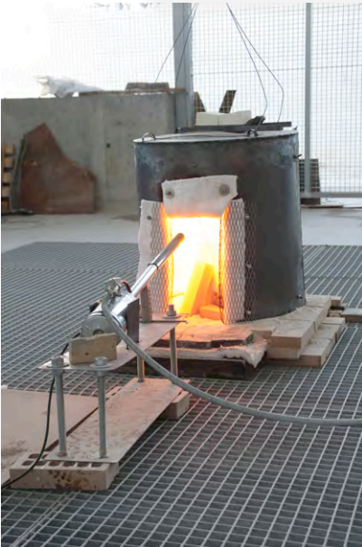
Figs. 246, 247: Detalle del horno para colada por crisol fusible encendido y pieza recién fundida.
