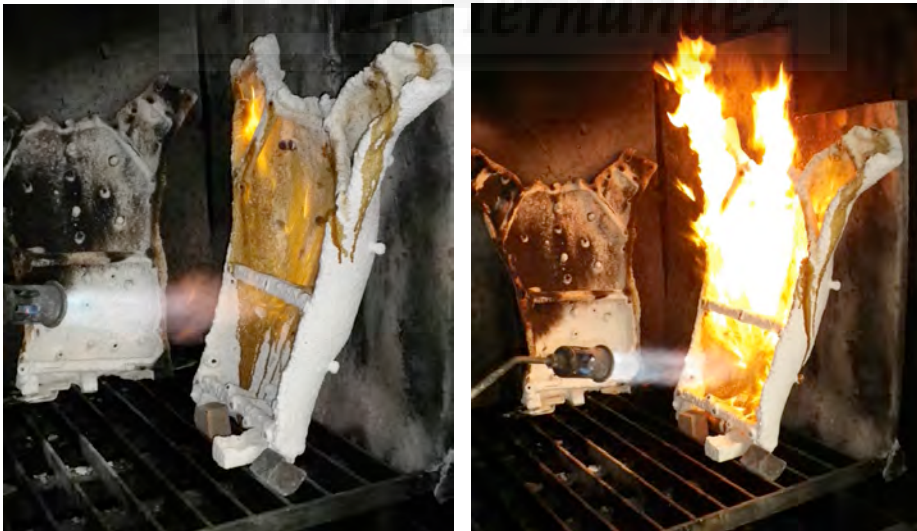
Fig.658: Inicio del proceso de descere, la cera se derrama por los orificios del molde.
