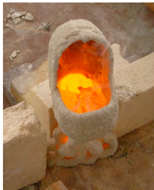
Figs. 239, 240, 241, 242, 243: Proceso de colada por volteo.
