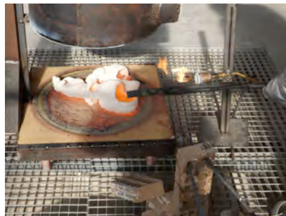
Figs.349, 350: Imágenes de coladas por volteo con dos cascarillas dentro del nuevo horno para microfusión.
