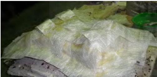
Fig.624: Aplicación de la fibra de vidrio para generar la carcasa.
