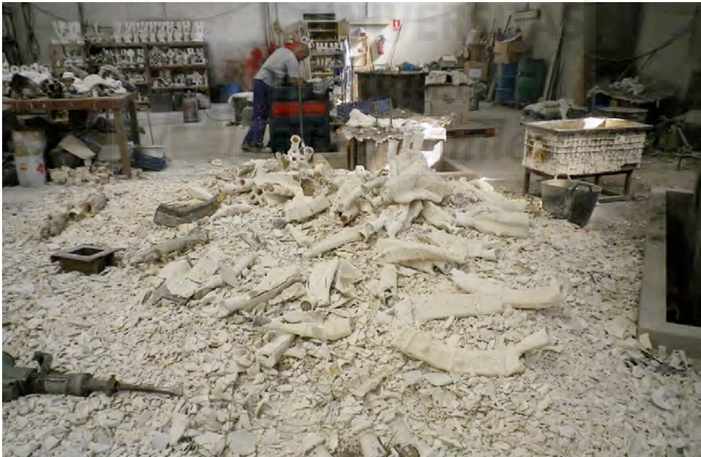
Fig.702: Vista de la zona de descascarillado, con algunas piezas que empiezan a intuirse entre los escombros de cascarilla cerámica. Observamos también alguna de las herramientas utilizadas en dicho proceso como el martillo percutor que aparece a la izquierda de la imagen.
