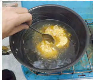
Fig.71: Adición de la resina de colofonia.
