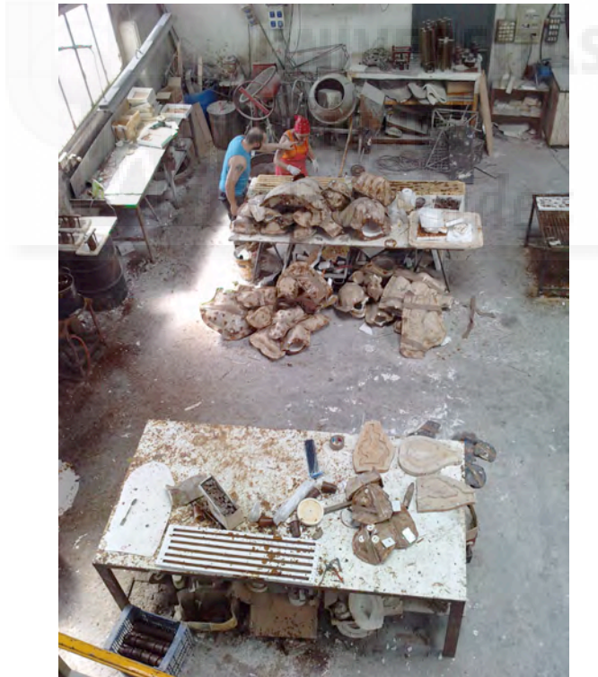
Fig.687: Vista general de la zona de ceras: vemos a la izquierda de la fotografía los bidones con las ceras líquidas, y en el centro, los moldes que se preparan para ser positivados. En la mesa de la parte inferior de la imagen podemos ver los moldes de los bebederos, que serán cortados según las necesidades de cada árbol.
