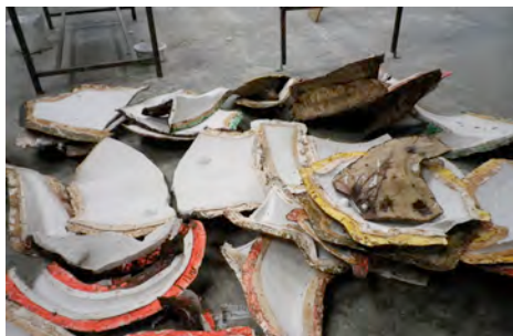
Fig.600: Modelado de las piezas en escayola sobre poliestireno expandido para Portokaelos . Fig.601: Fragmentos de los moldes de silicona con madre de resina de poliéster.
