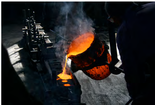
Figs.559,560: Moldes de arena dispuestos y realización de la colada.
