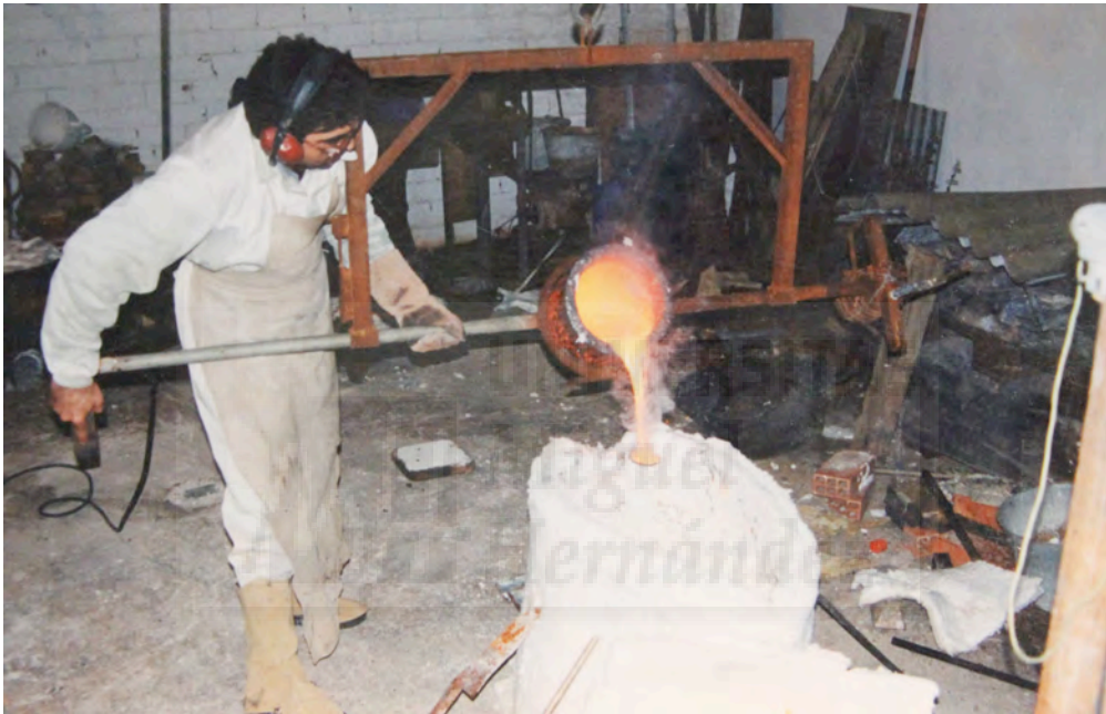
Fig.679: Jaume Espí fundiendo en su primer taller con el maneral asistido con contrapesos, montado para poder realizar la colada de manera autónoma.
