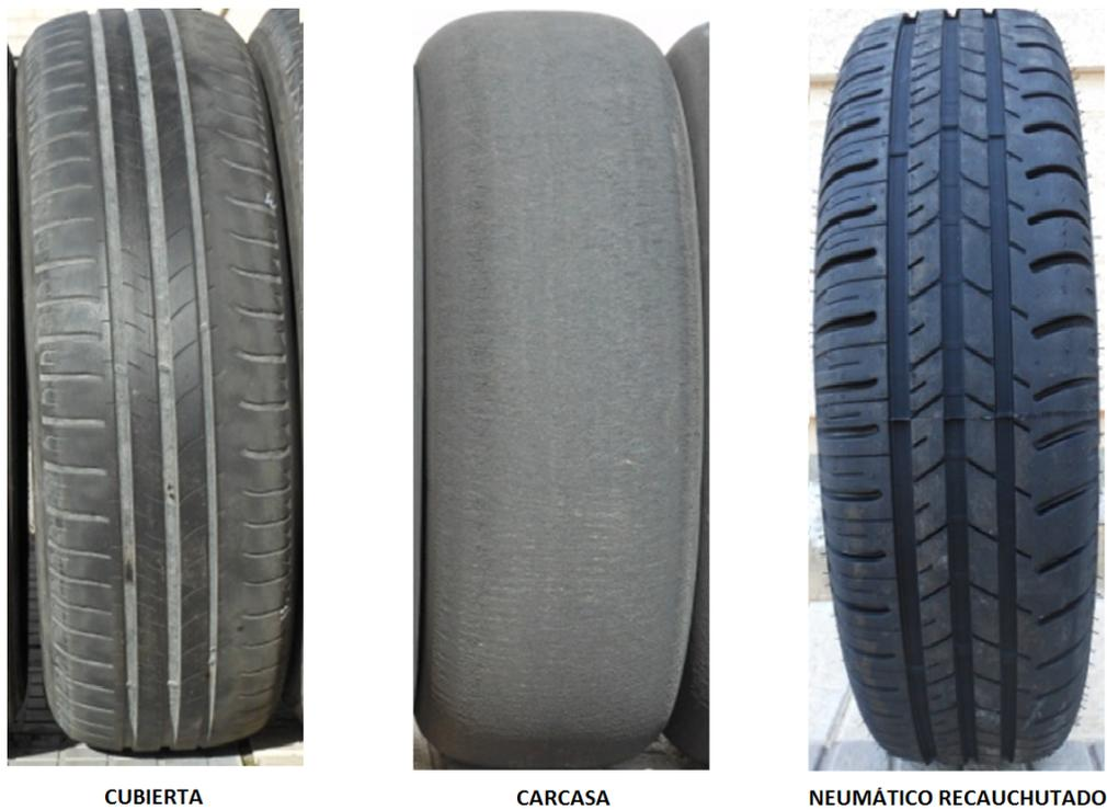
Figura 2.10: Cubierta, carcasa y neumático recauchutado
