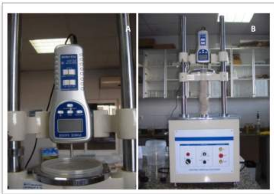
Ilustración 20.- Penetrómetro PTR 200 - S500 (A). Puesto de medición PCE - MT (B).
