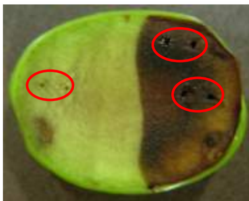
Ilustración 12.- Estado de la aceituna tras el análisis de la conductividad donde se aprecian las zonas punzonadas.
