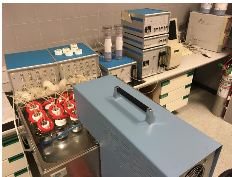
Figura 12. Respirómetro multisensor (MicroOxymax, Columbus, OH, USA) utilizado para la determinación de la respiración microbiana.
