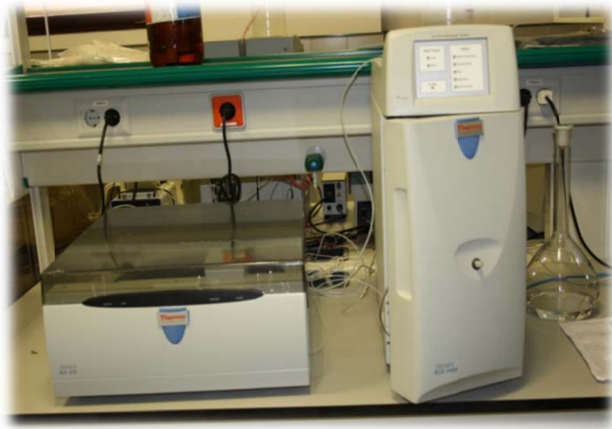
Figura 4. Cromatógrafo Dionex ICS-1100 utilizado para el análisis de cationes
