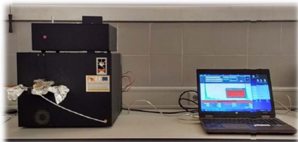
Figura 5. Analizador termo/óptico utilizado en la determinación de carbono orgánico y elemental.
