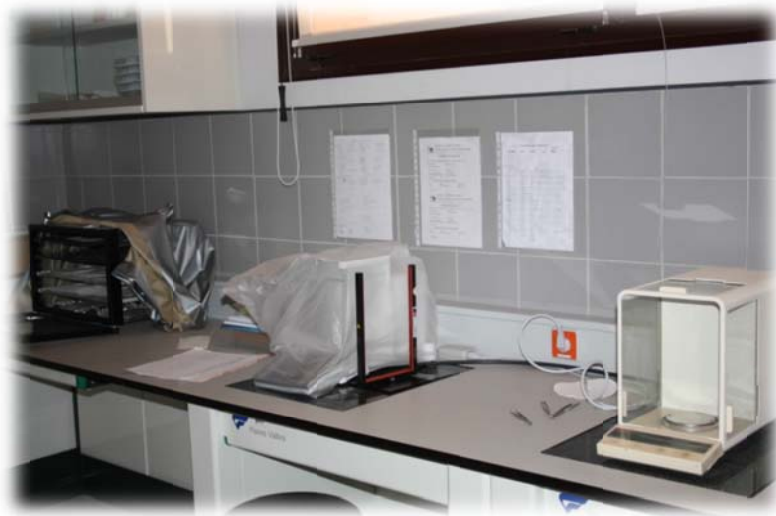
Figura 6. Sala para el acondicionamiento de los filtros previo al análisis gravimétrico.
