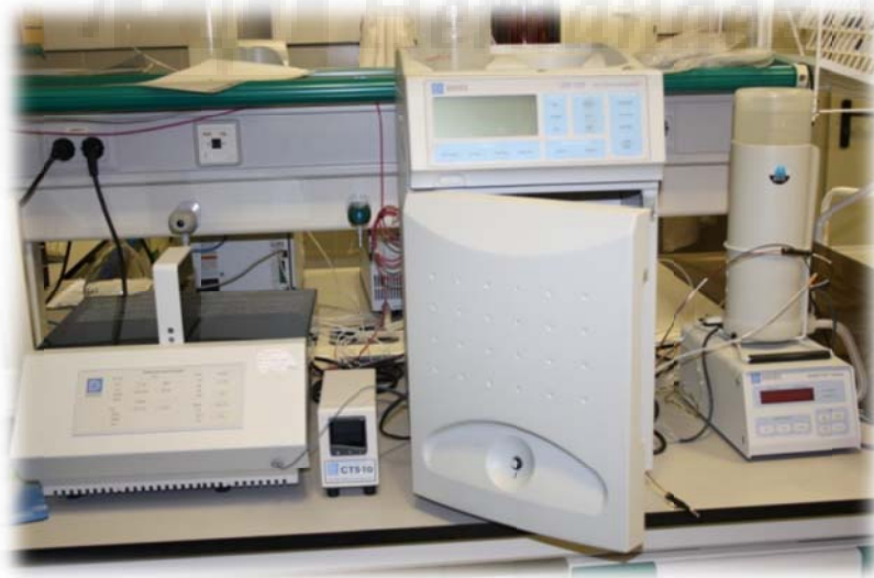
Figura 3. Cromatógrafo Dionex DX-120 utilizado para el análisis de aniones.
