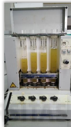
Figura 14. Equipo de filtración del residuo resultante de las muestras de harina.
