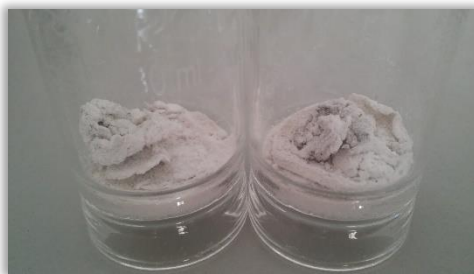
Figura 17. Residuo tras incineración.
