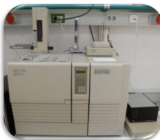
Imagen 19: Cromatógrafo de gases acoplado a un espectrómetro de masas Shimadzu GC-17A
