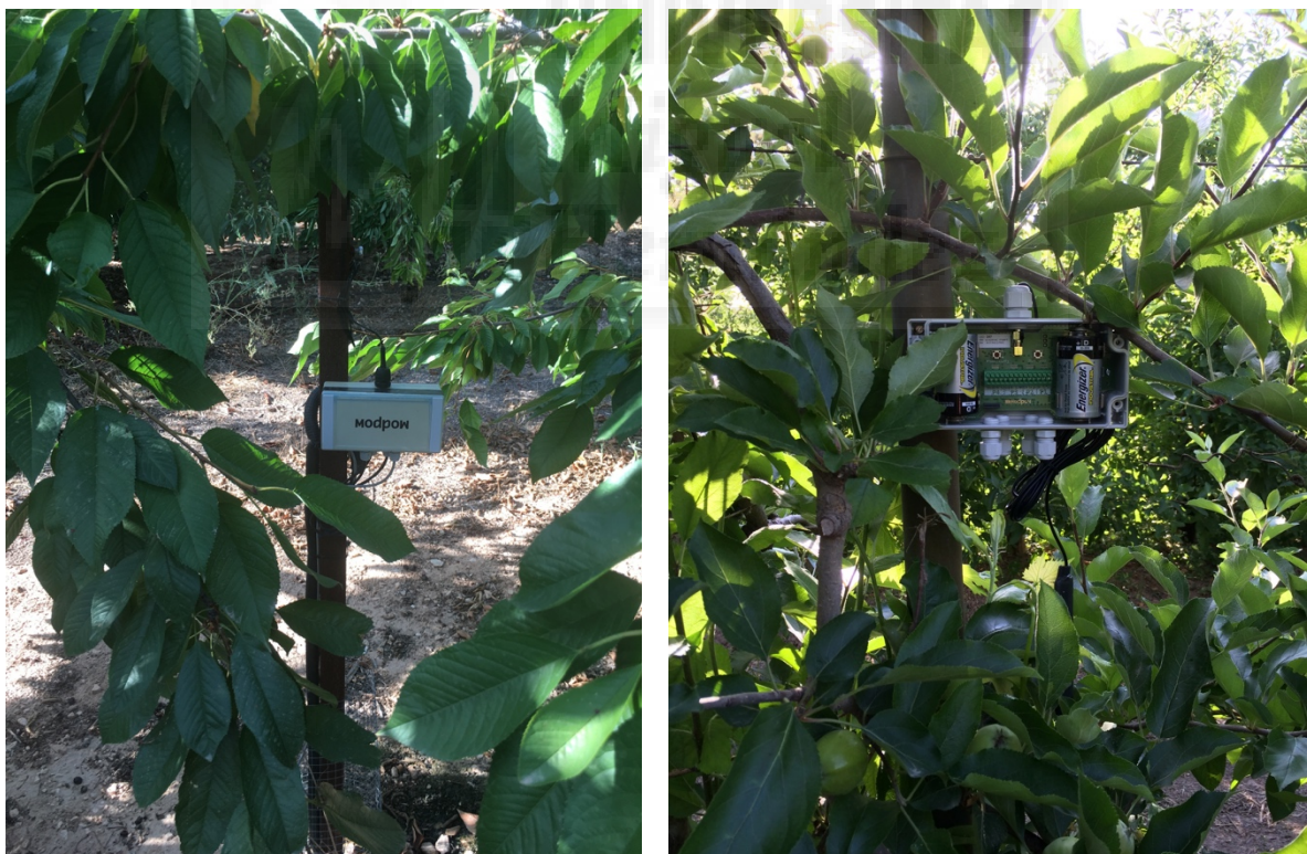
Figura 4: Detalle de un registrador de datos ( datalogger )
