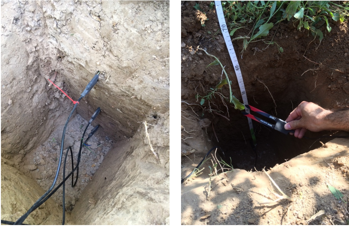
Figura 5: Detalle de la instalación de los sensores FDR a diferentes profundidades.
