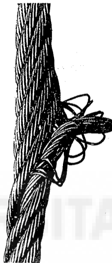
Cliché 10 - Quebradura o extrusión del alma de acero generalmente como consecuencia de una deformación en cesta en una zona próxima. El cable debe ser retirado inmediatamente.
