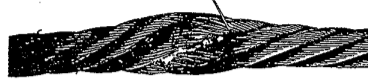
Cliché 18 - Aplastamiento por acción mecánica que da lugar a un laminado del cable. El cable debe ser retirado.
