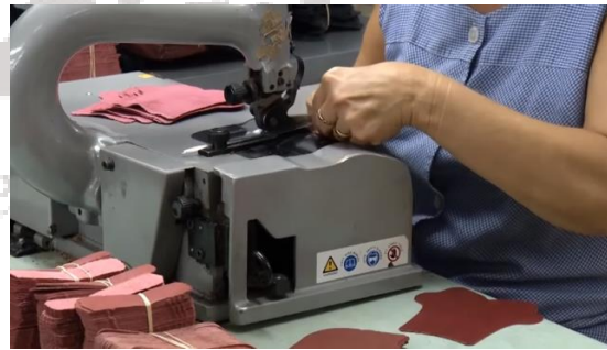
Imagen 21. Proceso de rebajado de la piezas
