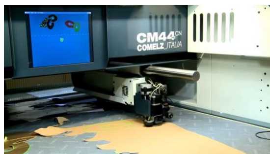
Imagen 31. Cortado de piel con máquina digital por láser
