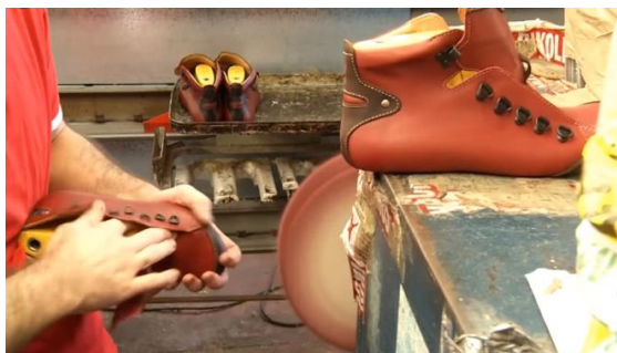
Imagen 24. Proceso de cepillado manual con cera de abeja
