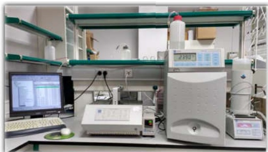
Figura 4. Cromatógrafo Dionex DX-120 utilizado para el análisis de aniones.
