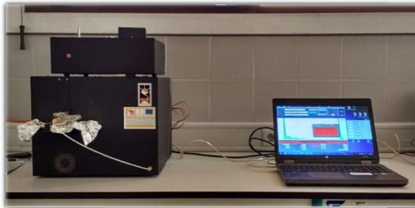
Figura 6. Analizador termo/óptico utilizado en la determinación de carbono orgánico y elemental.
