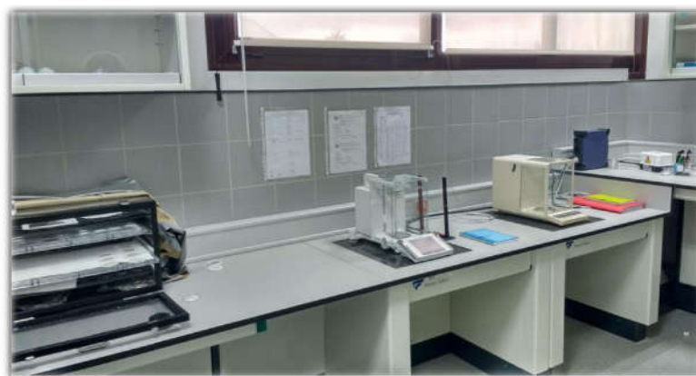
Figura 7. Sala para el acondicionamiento de los filtros previo al análisis gravimétrico.
