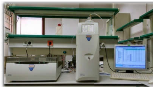
Figura 5. Cromatógrafo Dionex ICS-1100 utilizado para el análisis de cationes.
