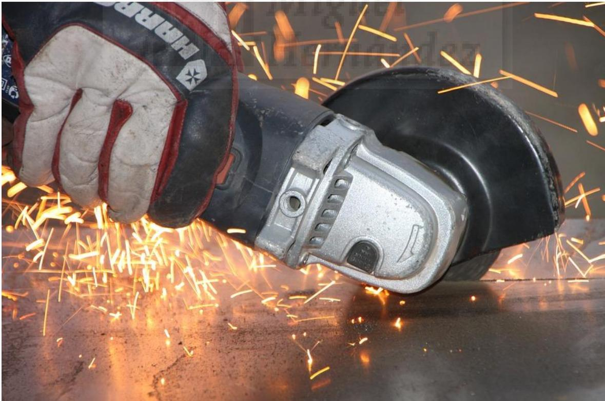
Fig. 4 Amoladora en funcionamiento
