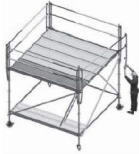
Imagen 38. Montaje de pies y largueros de seguridad. (NTP 696)
