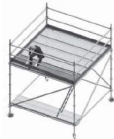
Imagen 39. Montaje de barandillas y rodapiés desde el nivel superior. (NTP 696)
