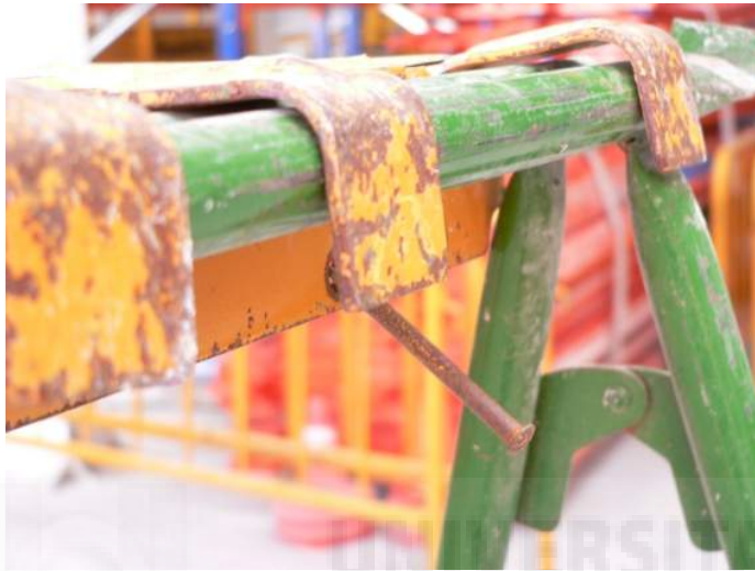
Imagen 45. Plataforma metálica anclada a la borriqueta. ( www.seguridadenlaconstruccion.es )
