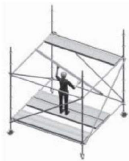
Imagen 37. Montaje de pies, brazos, diagonales y plataformas del primer nivel. (NTP 696)
