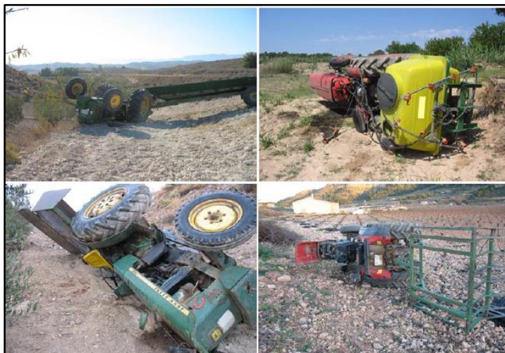
Imagen 6. Fotografías de diversos tractores volcados sin estructura de protección
