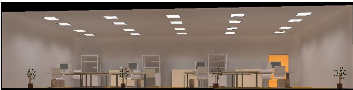
La intensidad lumínica obtenida en el plano útil es de 606 lux, con un ratio de potencia de 10,91 W/m<sup>2</sup> y un VEEI de 1,80.
