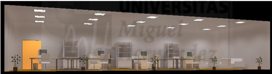
La intensidad lumínica obtenida en el plano útil es de 545 lux, con un ratio de potencia de 10,63 W/m<sup>2</sup> y un VEEI de 1,95.
