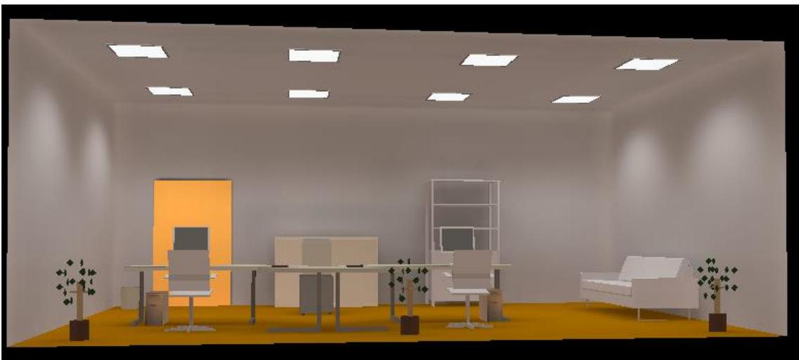
La intensidad lumínica obtenida en el plano útil es de 566 y 568 lux, con un ratio de potencia de 11,3 W/m<sup>2</sup> y un VEEI de 2 y de 1,99.
