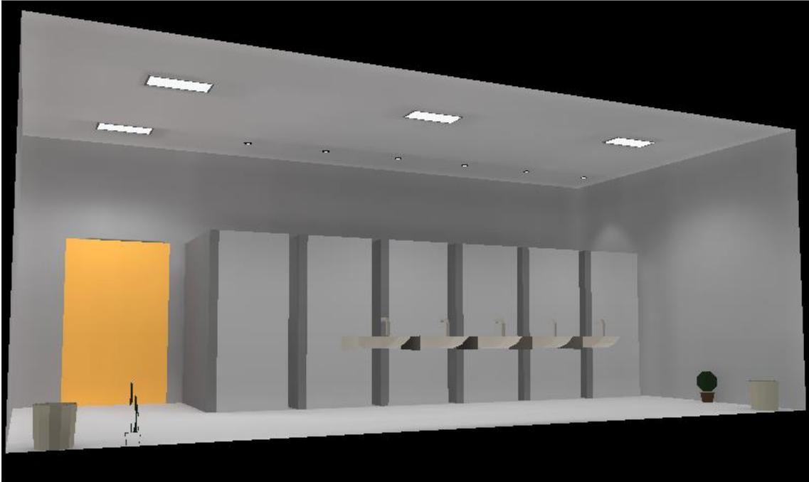
La intensidad lumínica obtenida en el plano útil es de 349 lux, con un ratio de potencia de 9,19 W/m<sup>2</sup> y un VEEI de 2,63.
