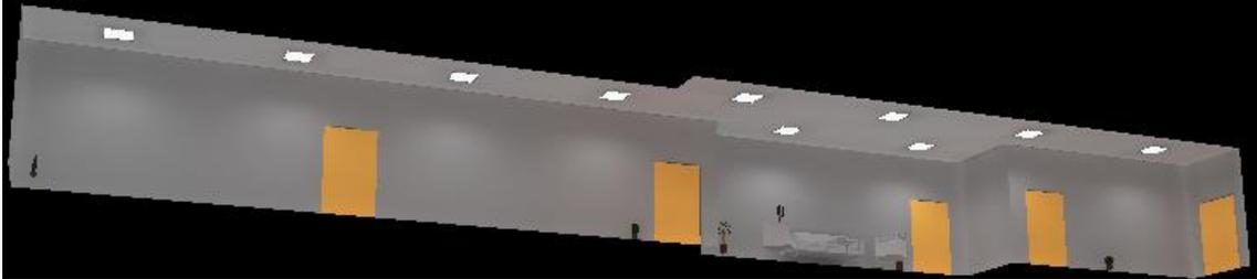
La intensidad lumínica obtenida en el plano útil es de 336 lux, con un ratio de potencia de 6,42 W/m<sup>2</sup> y un VEEI de 1,91.
