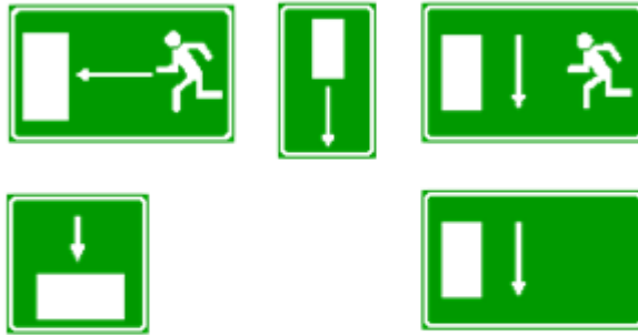
Vía/salida de socorro
