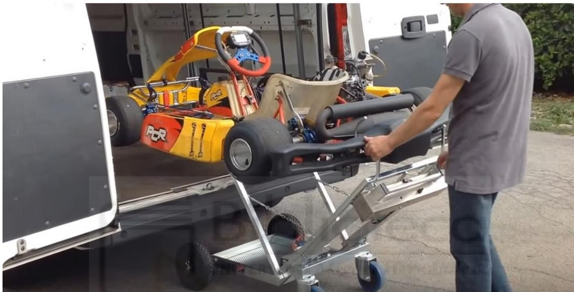
Ilustración: Carro porta karts realizando la carga del kart al vehículo.
