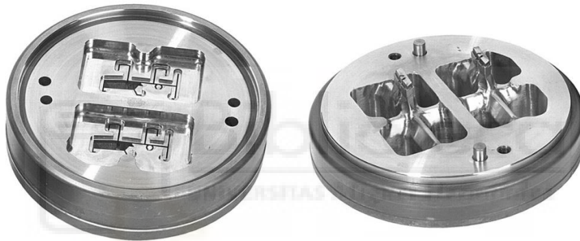
Figura 6. Matriz porthole o tubular desmontada (Cortesía de Hydro Extrusion Spain).
