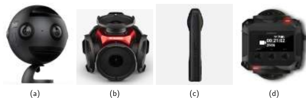
Figura 2.4: Sistemas de imágenes esféricas comerciales: (a) Insta360 PRO diseñado por Insta360 [134], (b) Ladybug6 producido por FLIR [135] (c) RICOH THETA Z1 presentado por THETA [136] y (d) Garmin VIRB 360 diseñado por Garmin [137].
