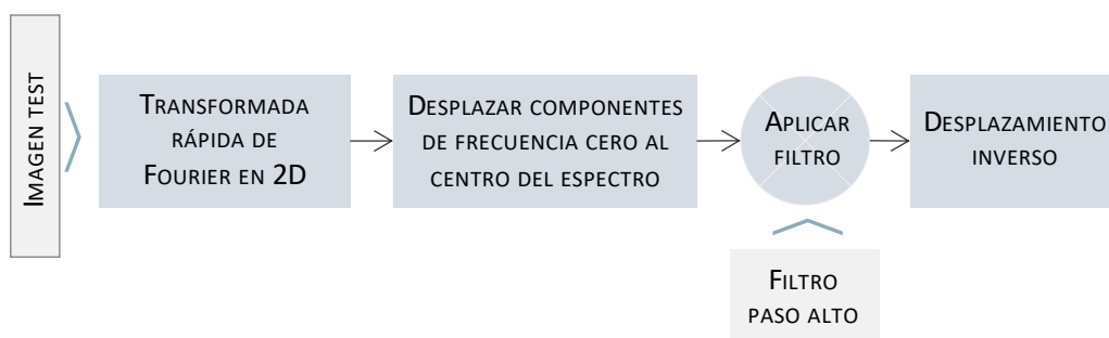
Figura 5.7: Diagrama de bloques para la obtención de la medida de calidad basada en la nitidez como resultado de realizar un estudio en el dominio de la frecuencia.
