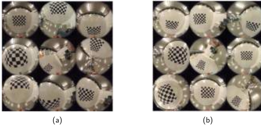
Figura 3.10: Ejemplo de imágenes utilizadas en el proceso de calibración: (a) nueve imágenes fisheye del primer conjunto de imágenes (lente delantera) y (b) nueve imágenes fisheye del segundo conjunto (lente trasera).
