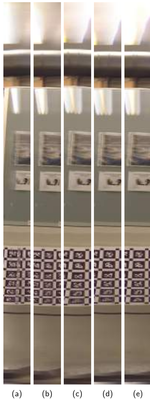
Figura 5.27: Captura en el laboratorio. Zonas de solape a evaluar: (a) VIRB, (b) MCS, (c) PE, (d) PE+\theta y (e) PE+\theta+r .
