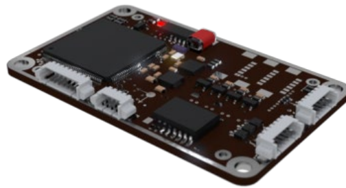
Figura 37. Ordenador de a bordo NanoMind A3200. Extraído de [85].
