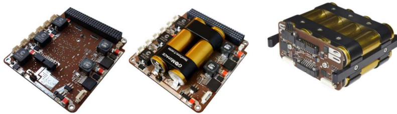
Figura 15. Izquierda, NanoPower P31U sin baterías, centro, NanoPower P31U con baterías integradas, derecha, kit de baterías externo. Extraído de [78].
