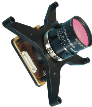
Figura 36. Cámara NanoCam C1U del fabricante GomSpace. Extraído de [112].
