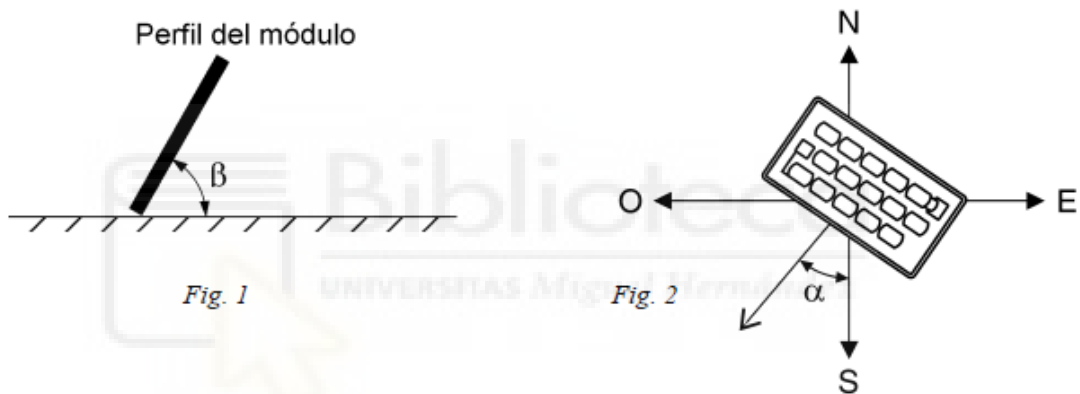
FIGURA 4: Inclinación y orientación de módulos
