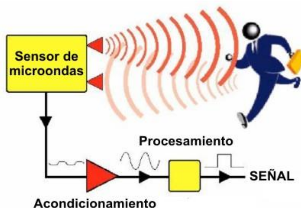
Figura 12: Funcionamiento sensor microondas
