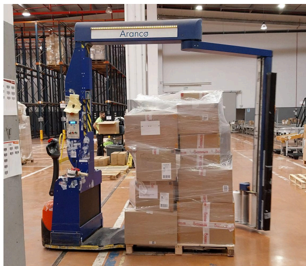
Ilustración 6 Máquina automática de flejado de palets. Fuente: elaboración propia.
