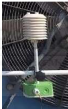
Figura 3.13: Termohigrómetro con capuchón.
