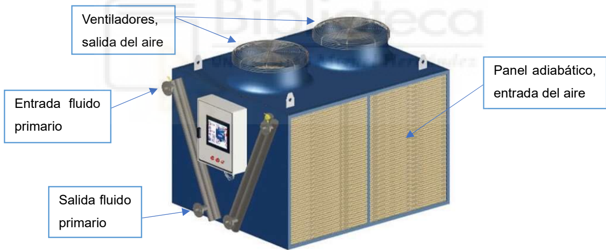
Figura 2.1: Imagen del aero-refrigerador con pre-enfriamiento adiabático. [8]
