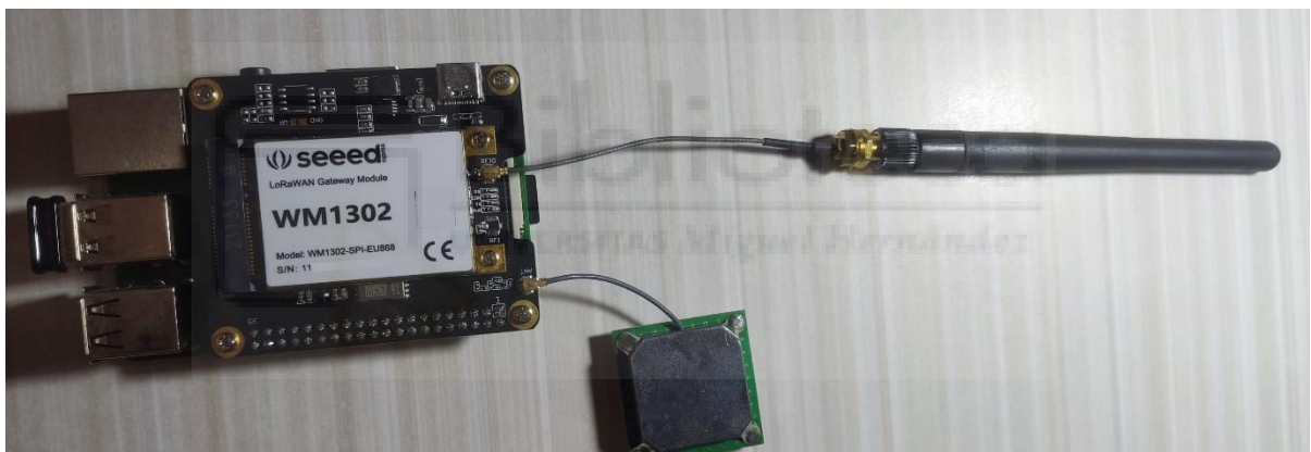
Figura 51. Puerta de enlace conectada a la Raspberry Pi.
