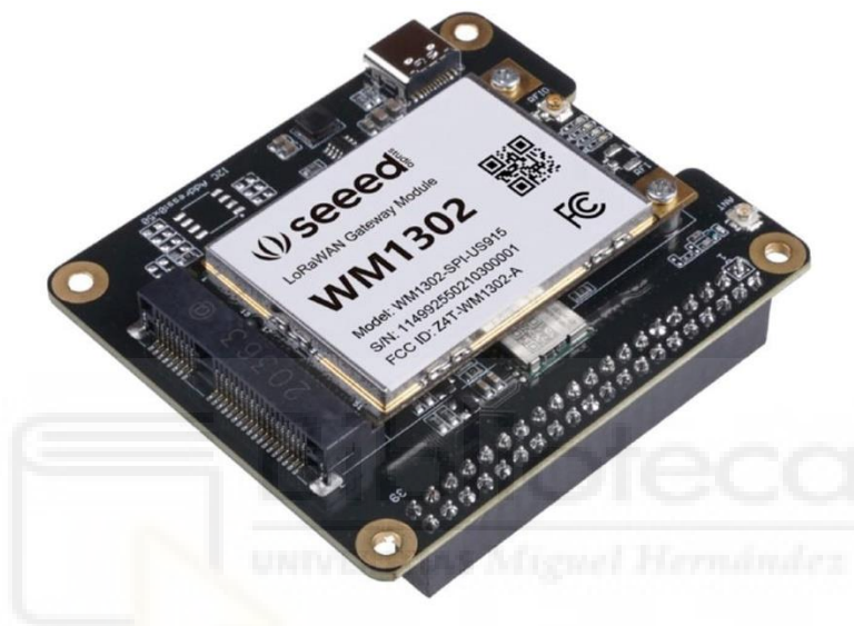
Figura 9. Puerta de enlace WM1302 con la PCB para conectar en una Raspberry Pi.
