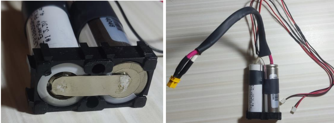
Figura 59. Batería LiFePO4 fabricada para el TFG.
