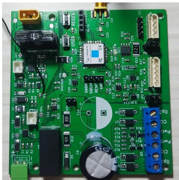
Figura 65. PCB con el microcontrolador soldado.
