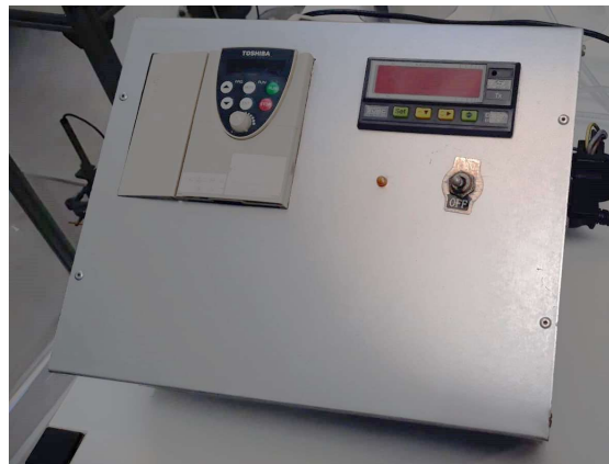
Figura 7. Variador de frecuencia Toshiba
