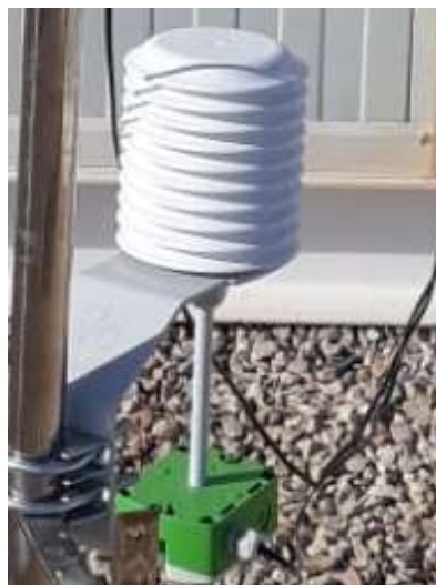
Figura 13. Sensor de humedad relativa y temperatura Young
