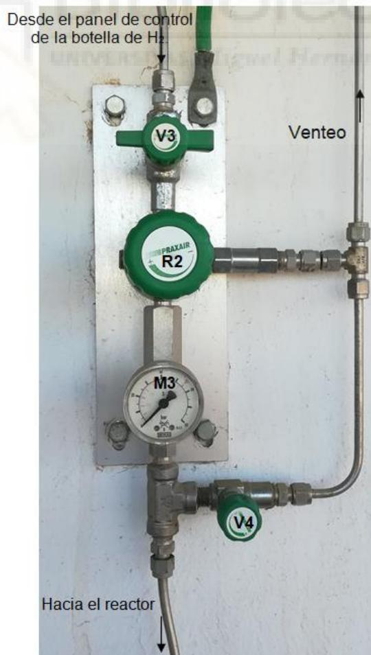
Este cuadro está compuesto de válvula de corte de  $\frac{1}{4}$  de vuelta (V3), regulador de presión (R2) con manómetro medidor con fondo escala de 80 bar (M3) y válvula de corte de  $\frac{1}{4}$  de vuelta (V4) para venteo y despresurización, así como salida en tubería con racor de acople para recipiente de hidrogenación (reactor).
