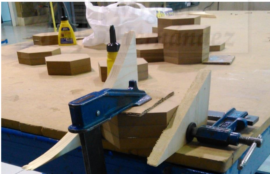
(Fig.6) Proceso de encolado de las piezas.
