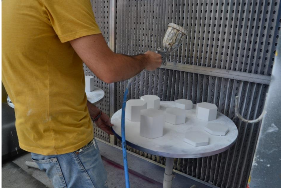
(Fig.7) Proceso de pintado de las piezas.
