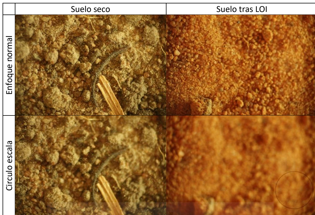
Figura 6. Ejemplo de fotografías de la una muestra de suelo, antes y después de ser sometida a la determinación del contenido en materia orgánica mediante calcinación (LOI). En la fila inferior se muestran las mismas imágenes enfocando el círculo de escala.
