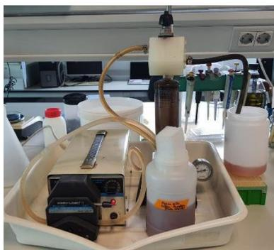
**Figura 3.2.-** Imagen del montaje realizado para la extracción de azúcares de los diferentes efluentes (Elaboración propia).
