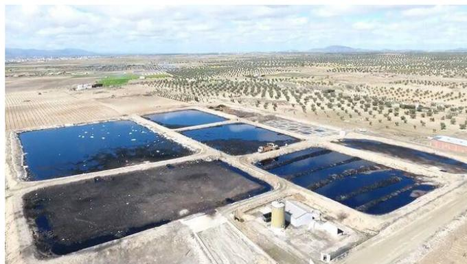
**Figura 1.5.-** Balsa de evaporación de aguas residuales (eIDíadeCórdoba, 2022).
