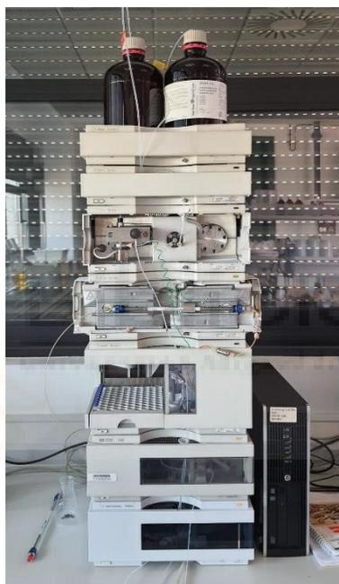
**Figura 3.6.-** Imagen del HPLC usado en la experimentación (Elaboración propia).
