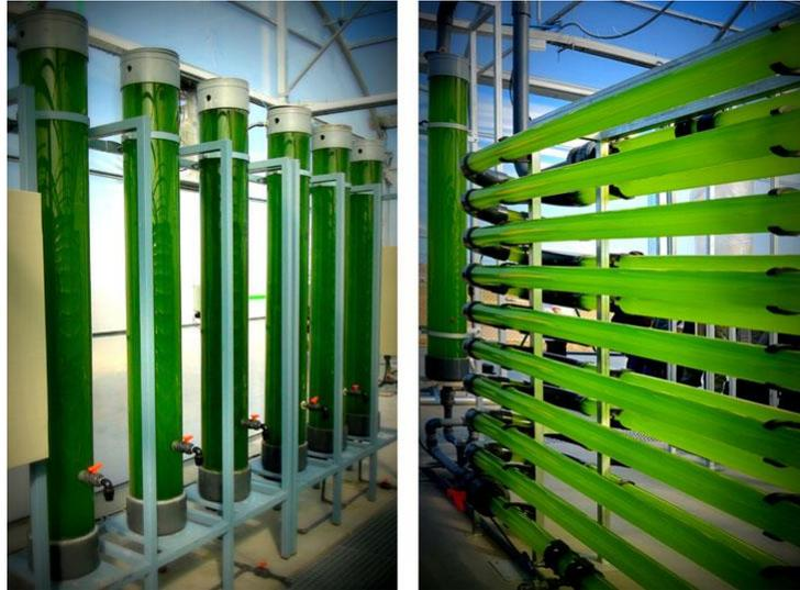
**Imagen N°2:** Planta de cultivo de microalgas en fotobiorreactores (Fuente: Google)
