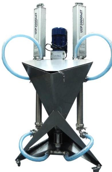
**Imagen N° 6:** Aparato empleado en extracción por ultrasonidos <sup>(4)</sup>
