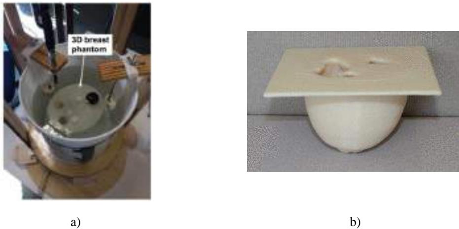
Fig 2.19. Modelos de mama con Triton X-100: a) Modelo de Triton X-100 donde se puede ver que es líquido [2.50]; b) molde fabricado con impresora 3D para rellenar con Triton X-100 [2.51].
