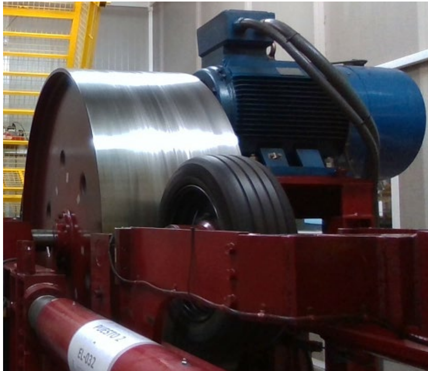
Figura 7. Ensayo de neumáticos mediante Drum-Test.
