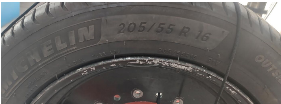
Figura 36. Detalle del código del neumático de ensayo.
