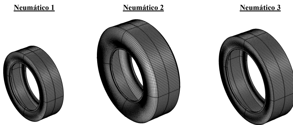
Figura 28. Geometría mallada de tres tipos de neumáticos diferentes.
