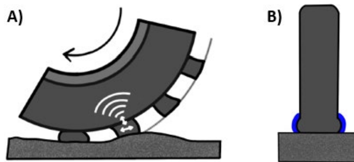
Figura 6. Esquema de los mecanismos de generación sonora: A. impacto y B. deformación.
