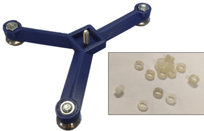
Figura 33. Base y casquillos impresos en 3D.
