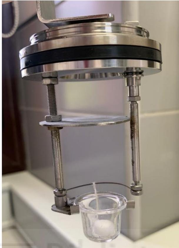
*Figura 8. Recipiente de disgregación con el ácido benzoico en contacto con la fibra de algodón preparado para el análisis [Fuente: Elaboración propia]*
