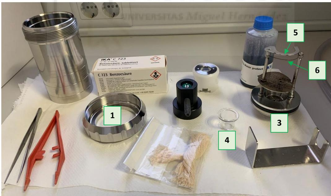
Figura 7. Accesorios externos del calorímetro. [Fuente: Elaboración propia]
