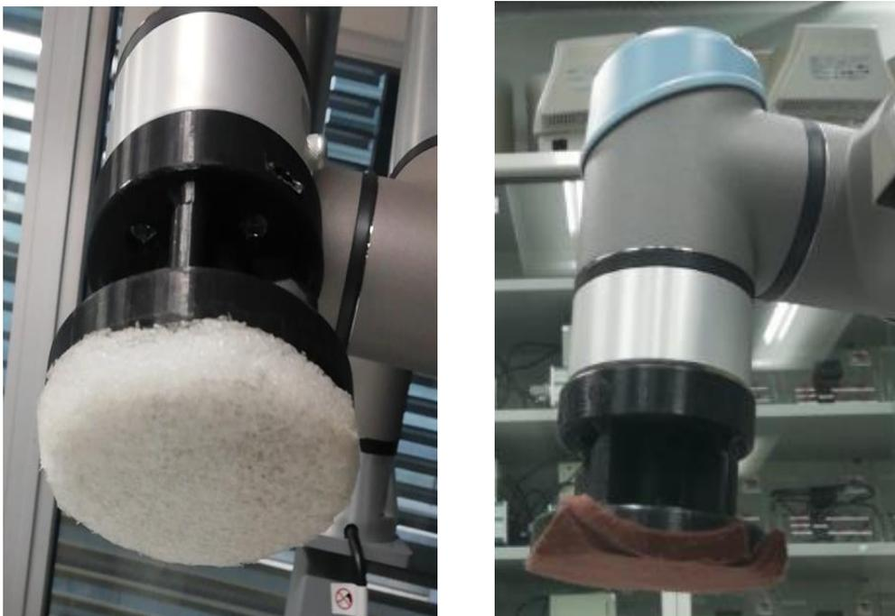
*Figura 49: Herramienta de Lijado*
