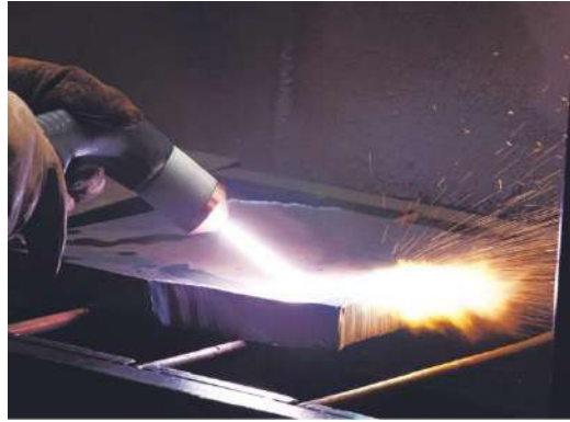
Figura 7. Soldadura de arco de plasma [11]
