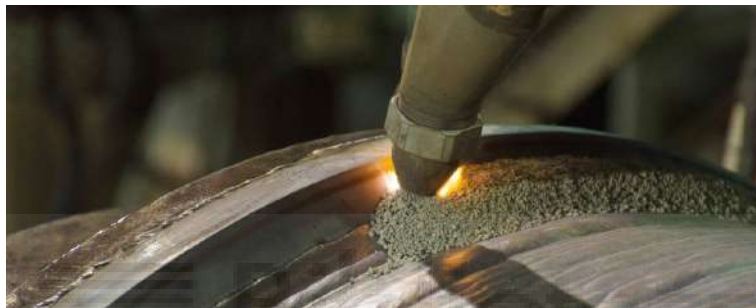
Figura 5. Soldadura por arco sumergido [9]
