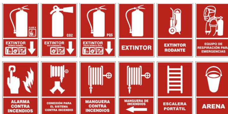
Figura 28. Equipos contra incendios [38]
