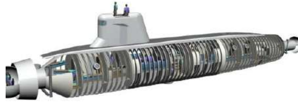
Figura 8. Estructura de un submarino [13]
