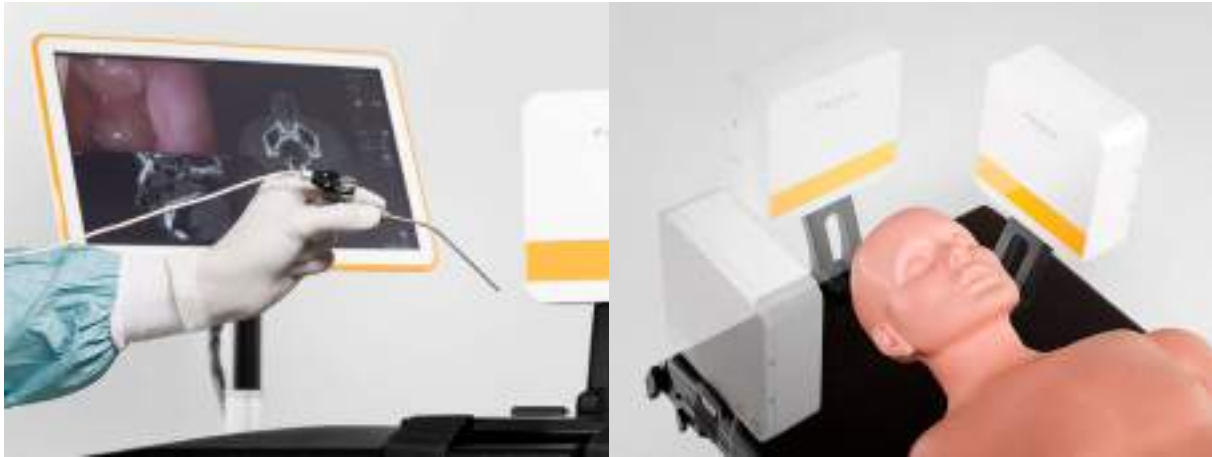
Fig. 20: Sistema comercializado de navegación EMG Kick EM®. A la izquierda, una sonda con el sensor EMG que informa de su posición al navegador. A la derecha, el Generador de Campo EMG alrededor de la zona de la intervención, en este caso, la cabeza del paciente.
