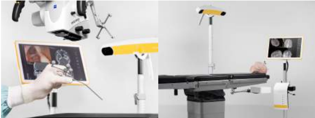
Fig. 23: Sistema de navegación híbrido comercializado Kick® & Kick® EM . A la izquierda, se aprecian un sonda con sensor EMG y con marcadores infrarrojos. Igualmente un microscopio óptico con marcadores IR para informar al navegador de su posición exacta por la cámara estereoscópica. A la derecha, una visión más amplia de la sala de operaciones.
