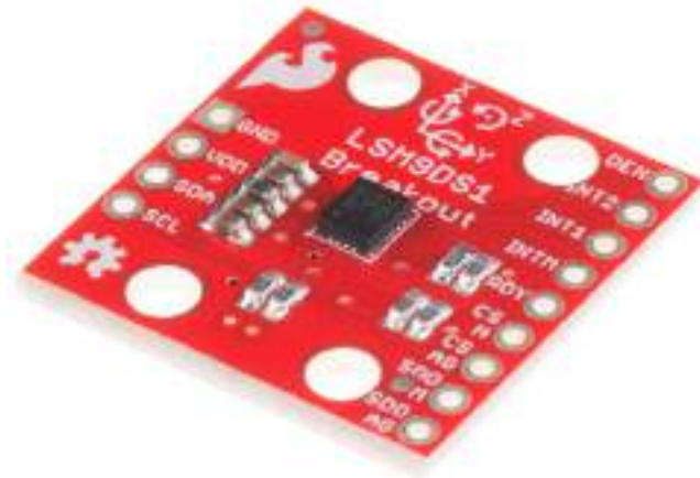
Fig. 25: Unidad de Medición Inercial (IMU). "SparkFun 9DoF-IMU-Breakout LSM9DS1 13284-02" del autor SparkFun bajo licencia CC-BY-2.0 vía Wikimedia Commons.
