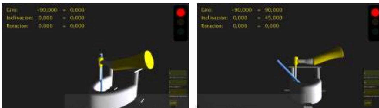
Fig. 32: Aspecto de la interfaz gráfica del navegador que integra la posición del contraángulo con la posición de planificación de los implantes, e informa acerca del acercamiento o alejamiento a esa posición en tiempo real.
