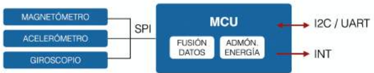
Fig. 46: Esquema que muestra los distintos componentes del BNO 055
