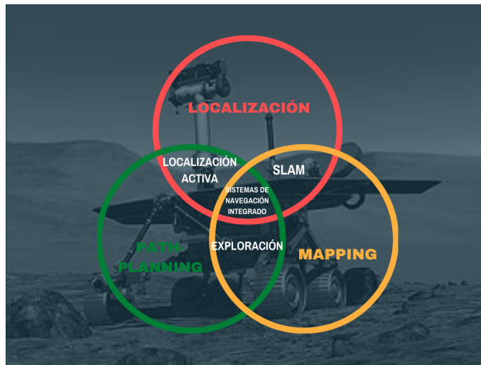
Figura 2.1: Relación entre localización, mapping y path-planning, conceptos que engloban la navegación integrada en robótica móvil.
