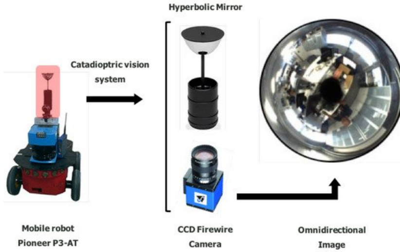
Figura 4.4: Robot móvil y su sistema de visión en la base de datos de INNOVA [5].
