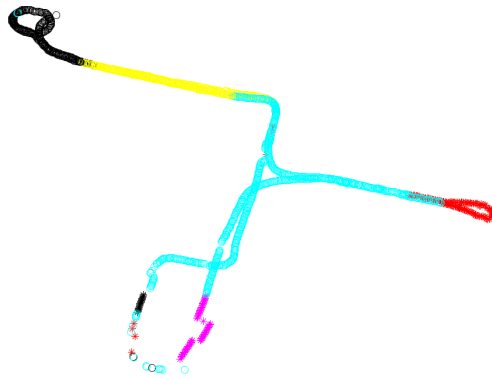
Figura 4.10: Mapa obtenido utilizando HOG, \gamma = 2,25 y \Omega = 1,7 en la base de datos de INNOVA. El proceso detecta 6 nodos y un valor medio de silueta de 0.3973.
