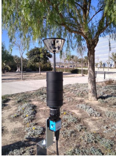
Figura 3.5: Cámara Imaging Source DFK 21BF04 y espejo hiperbólico Eizoh Wide 70 alineados para la captura de las imágenes omnidireccionales.
