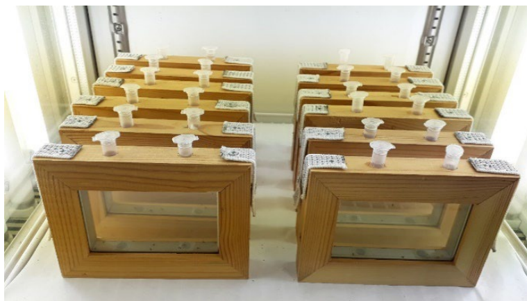
Figura 14. Cajas empleadas para evaluar la toxicidad residual de los aceites esenciales sobre Aphidius colemani .
