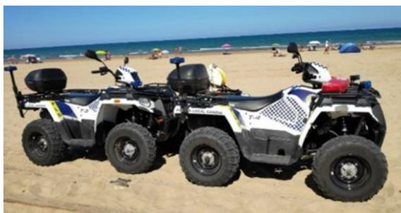
Generalmente denominados QUADS, pero concretamente para cumplir la labor profesional policial se apuesta por los cuadríciclos tipo ATV (All-Terrain Vehicle) los cuales vienen provistos de tracción a las cuatro ruedas (4x4).
