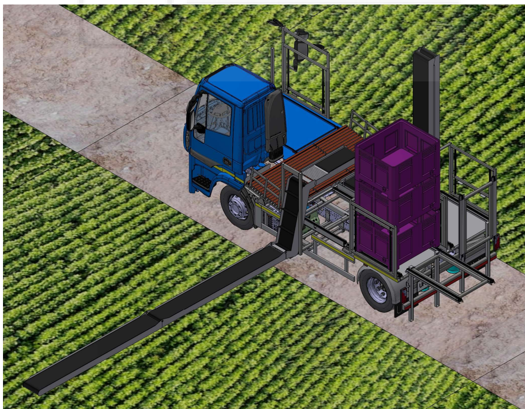
Fig. 4.5.19: Bloque completo de los tres palots en el apilador.
