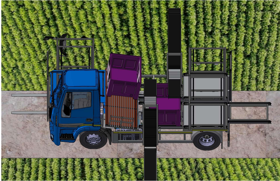
Fig. 4.3.12: 5º Paso bajada de bisagra y siguiente fase de la cadena.
