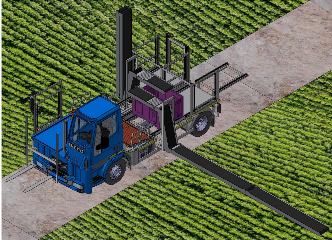
Fig. 4.4.17: Posición de llenado del palot.
