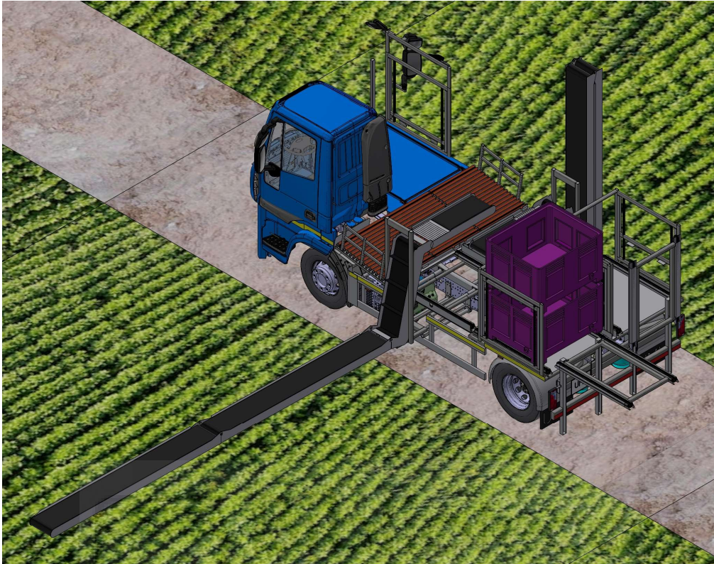
Fig. 4.5.16: Elevación del primer palot.
