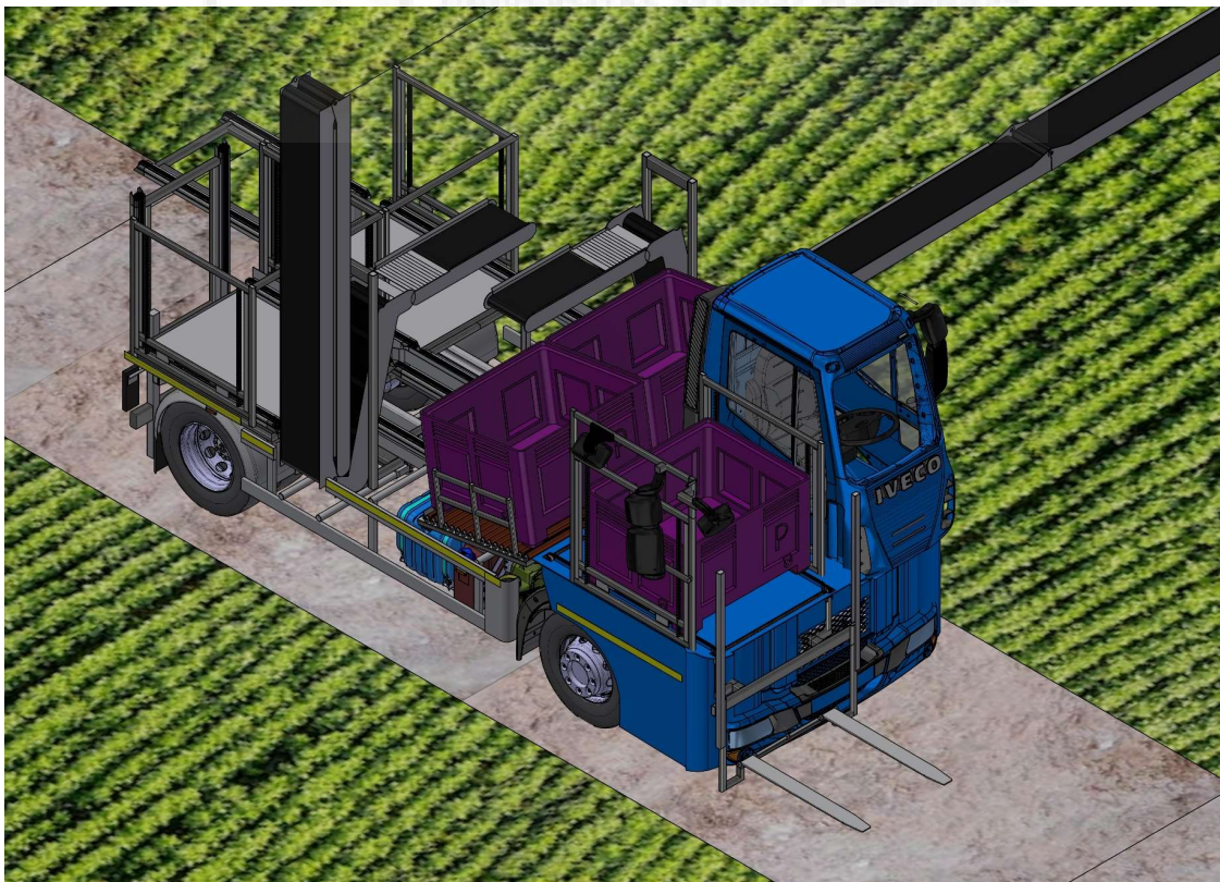
Fig. 4.2.18: 8º Paso de elevación y desafilación de los palots
