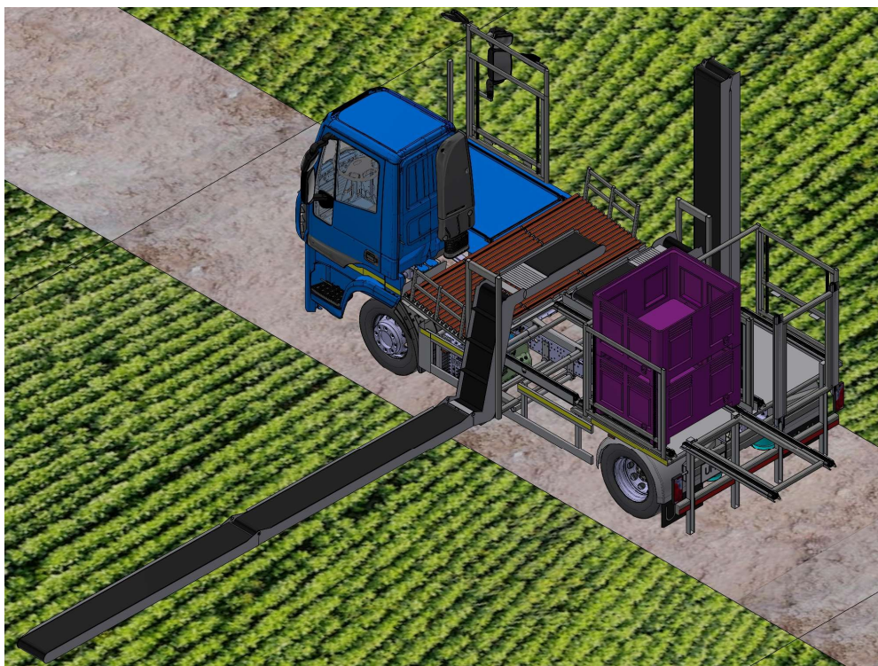
Fig. 4.5.17: Posicionamiento de primer palot sobre el segundo.
