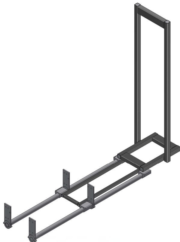
Fig. 4.4.11: Estructura de las cintas transportadoras (extendida).
