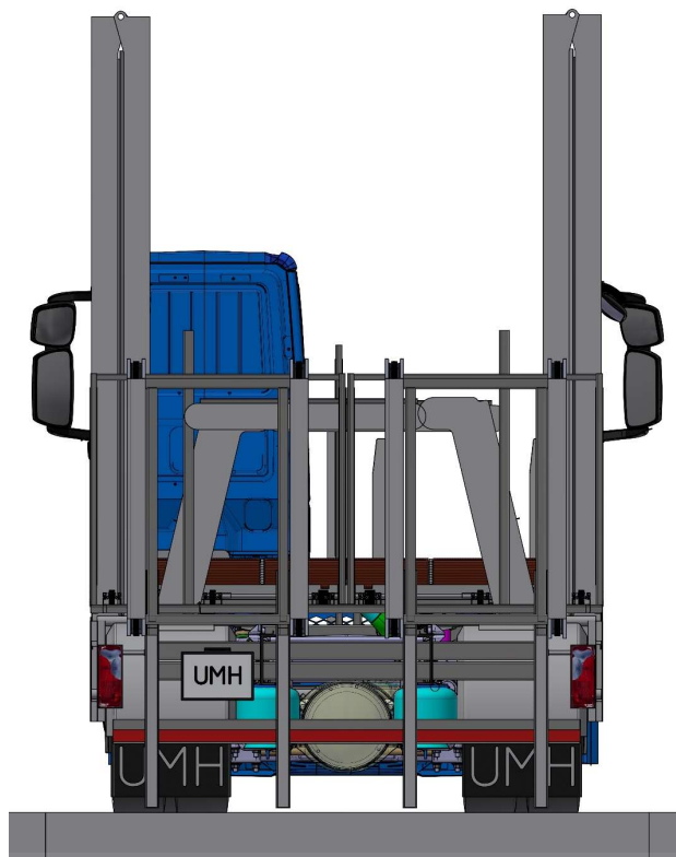
Fig. 6.9.8: Vista de la protección trasera del camión.
