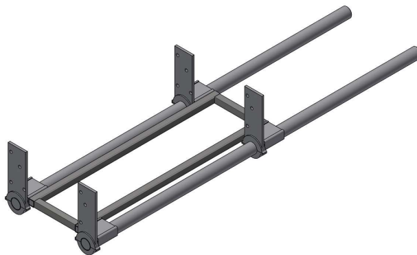
Fig. 4.4.9: Carro deslizadera anclado al chasis.
