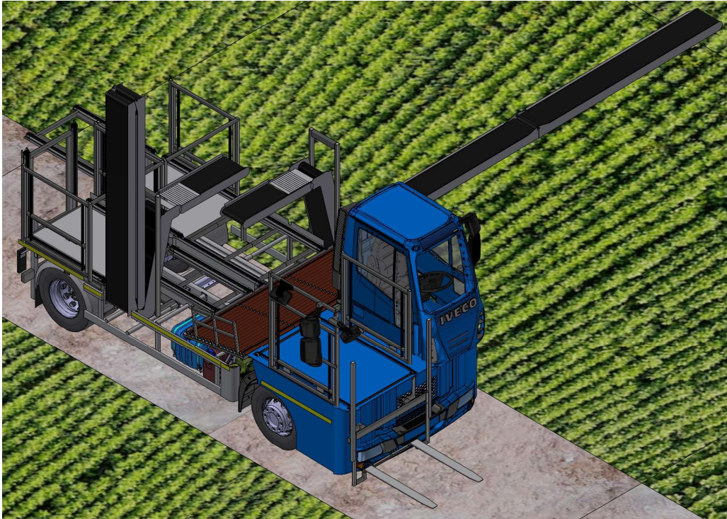
Fig. 4.4.16: Posición de circulación (plegada).
