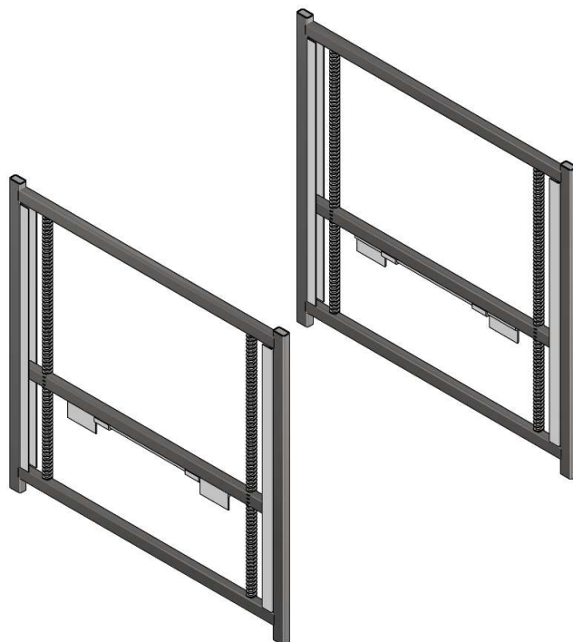
Fig. 4.2.5: Desapilador con pestañas en posición vertical.
