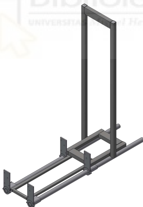
Fig. 4.4.11: Estructura de las cintas transportadoras (extendida).
