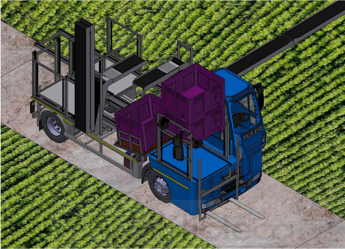
Fig. 4.2.16: 6º Paso de elevación y despalación de los palots.
