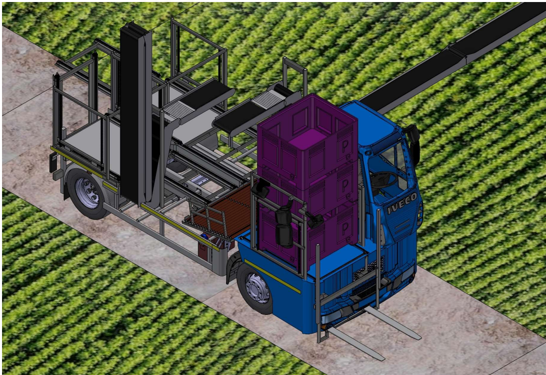
Fig. 4.2.15: 5º Paso de elevación y desapilación de los palots.
