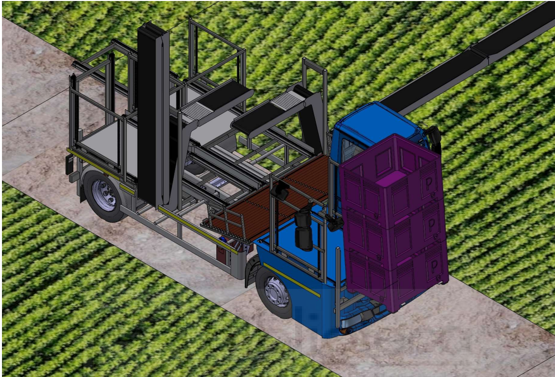
Fig. 4.2.13: 3º Paso de elevación y desapilación de los palots.
