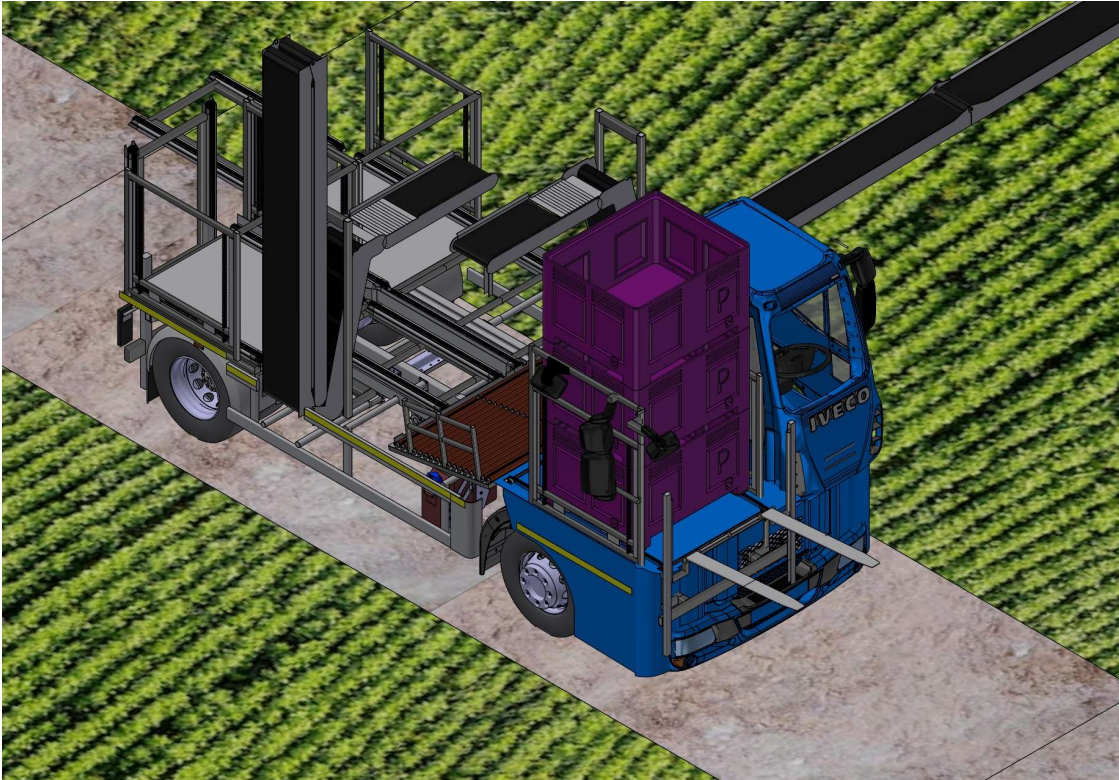
Fig. 4.2.14: 4º Paso de elevación y desapilación de los palots.
