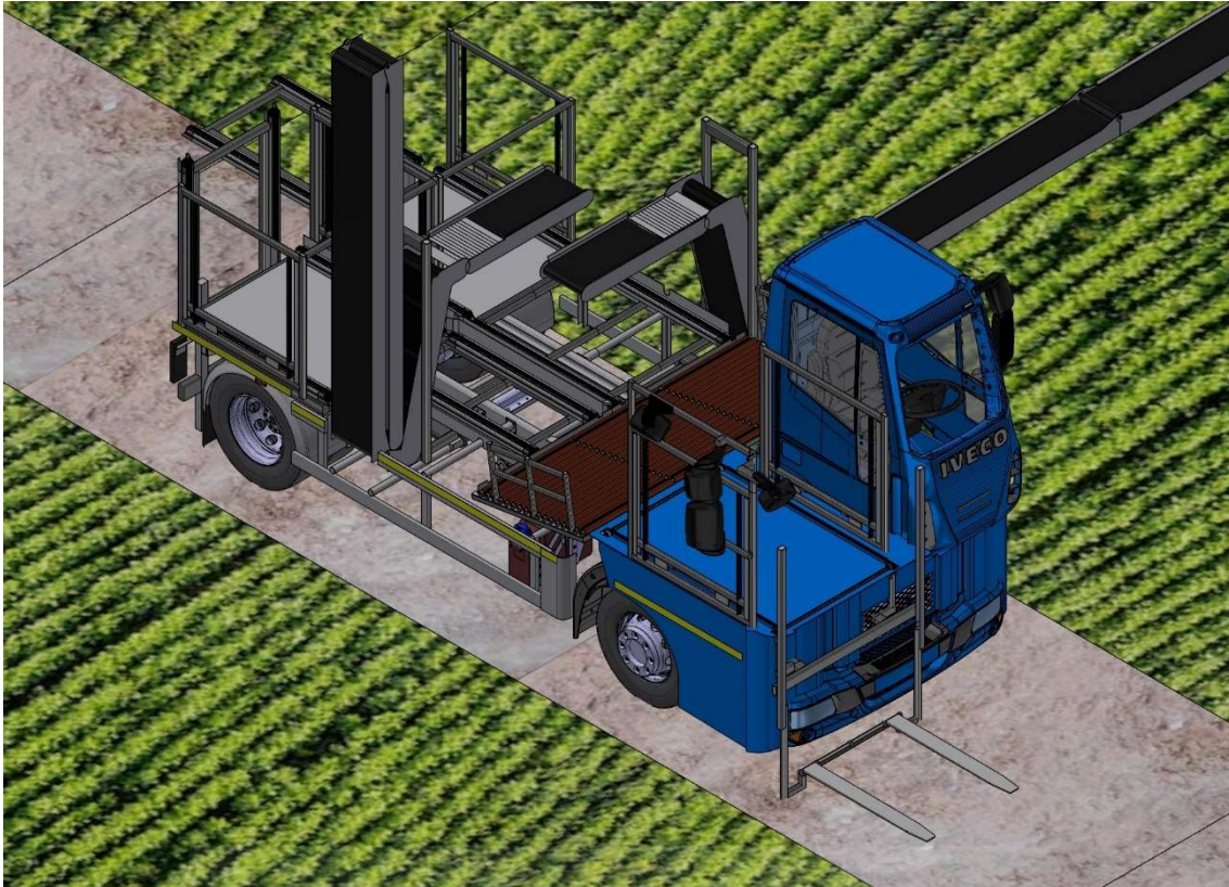
Fig. 4.2.11: 1º Paso de elevación y desapilación de los palots.
