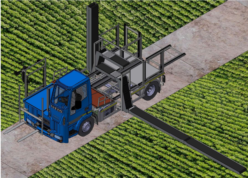
Fig. 4.4.15: Posición de recolección de sandías (extendida).
