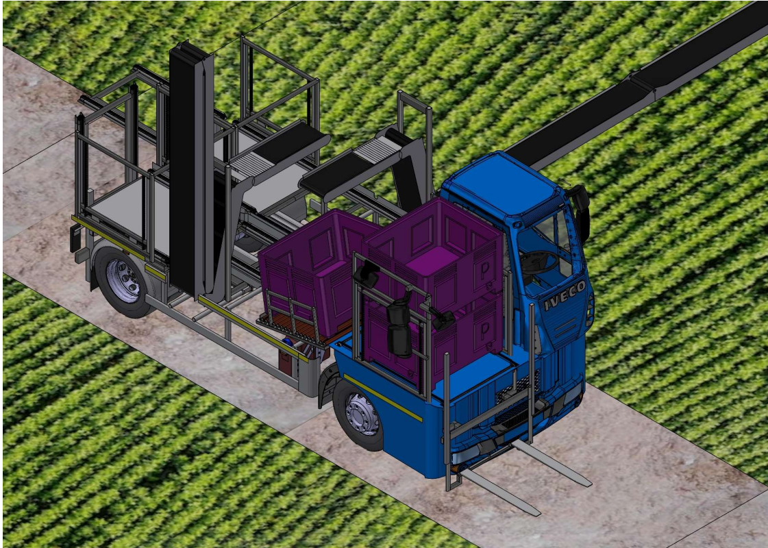
Fig. 4.2.17: 7º Paso de elevación y desafilación de los palots.
