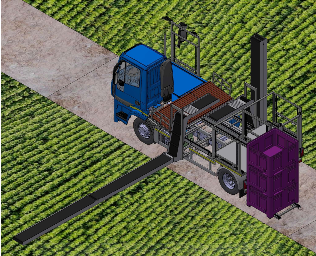
Fig. 4.5.21: Elevador en posición más baja y bloque de palots en el suelo.
