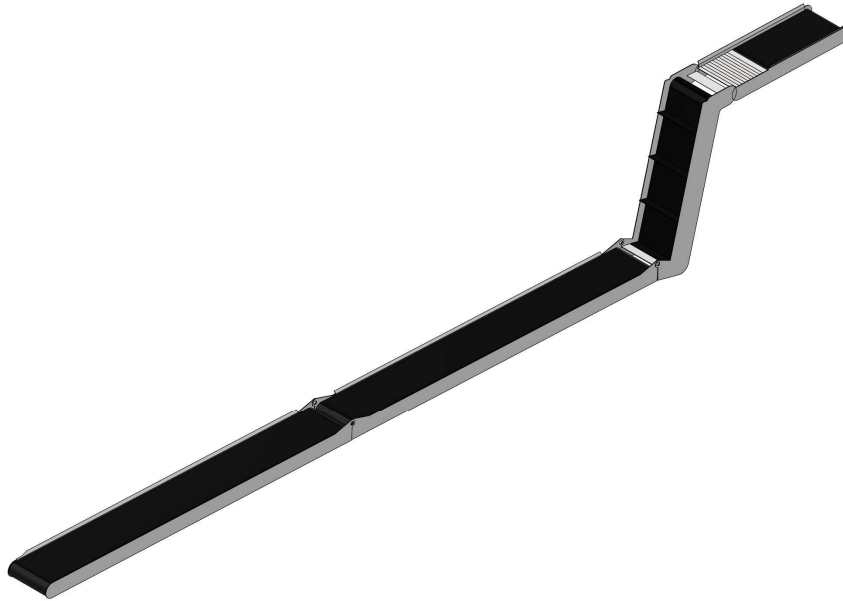
Fig. 4.4.14: Cintas transportadoras (extendida).
