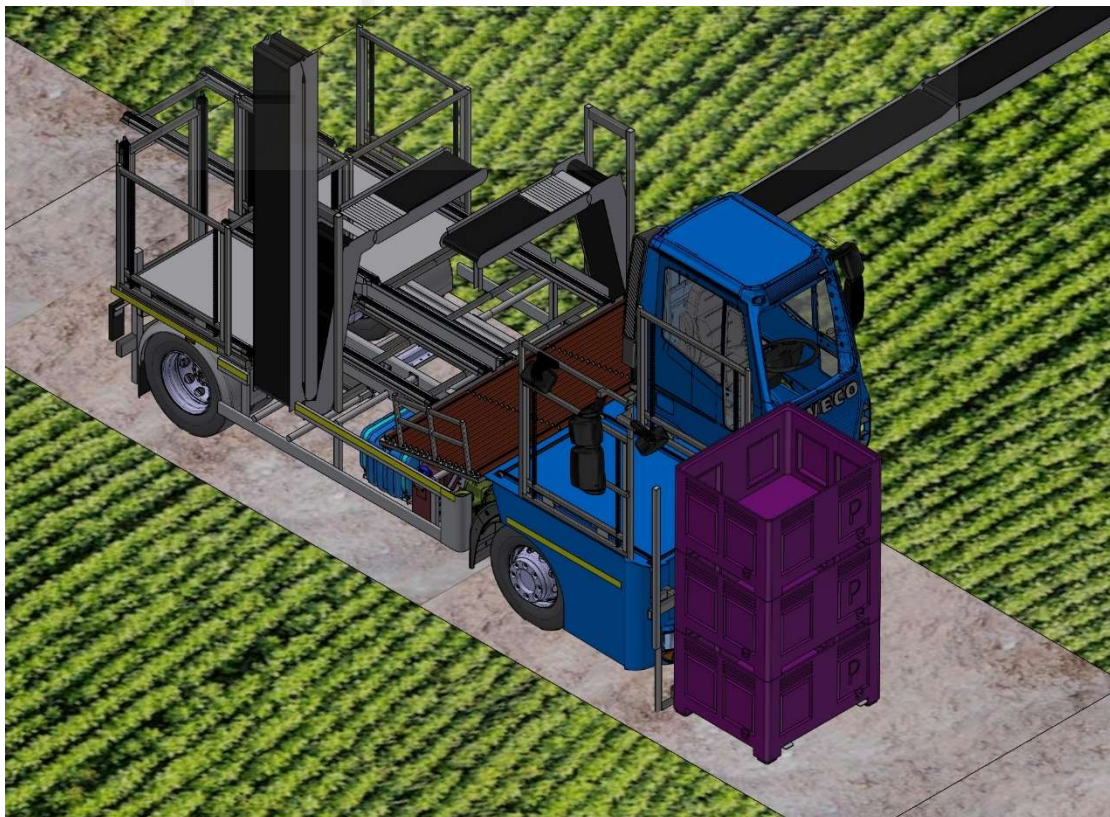
Fig. 4.2.12: 2º Paso de elevación y desapilación de los palots.
