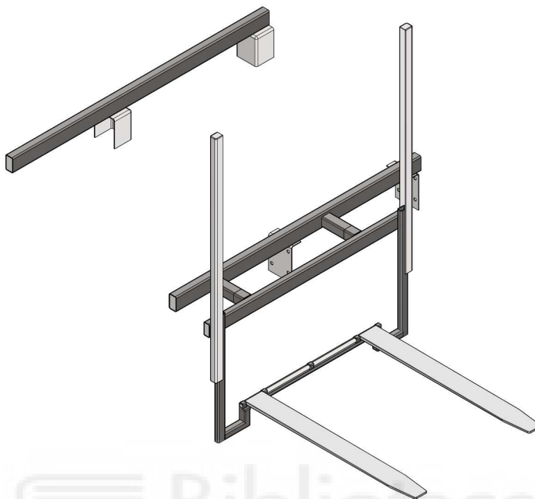
Fig. 4.2.8: Anclajes al chasis con la estructura delantera desplegado.
