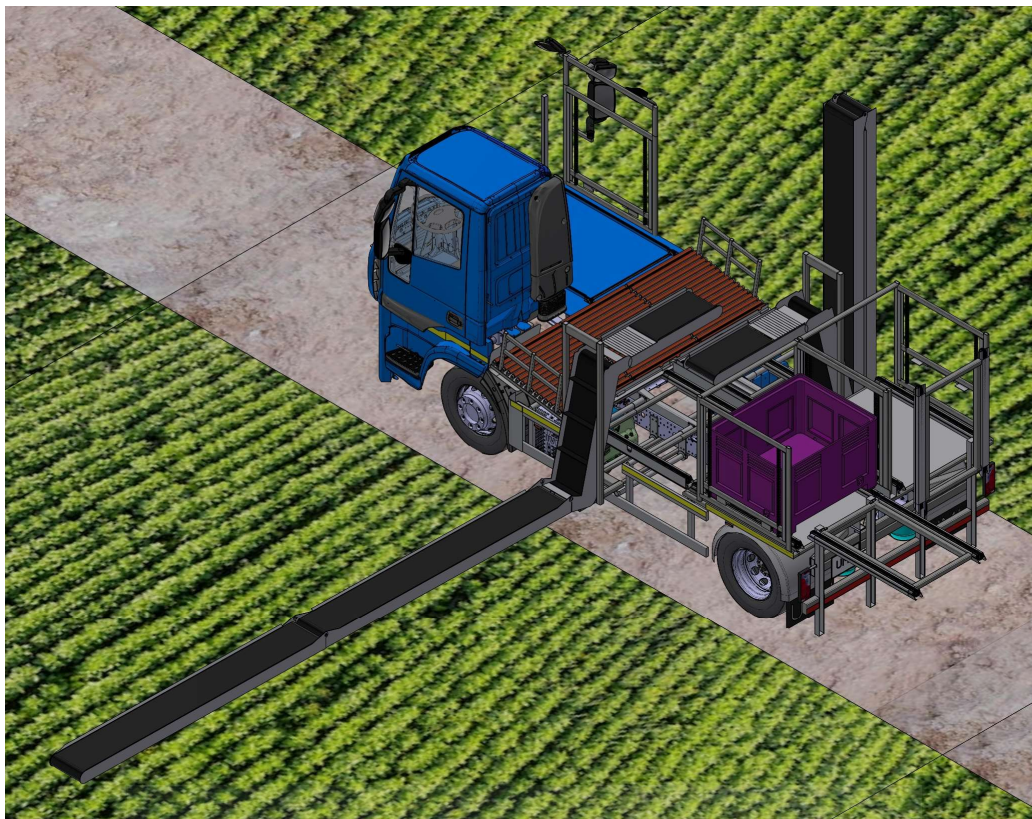
Fig. 4.5.14: Entrada del primer palot al apilador.
