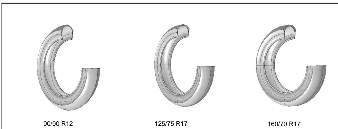
*Ilustración 19: Diferentes Ruedas Parametrizadas*
