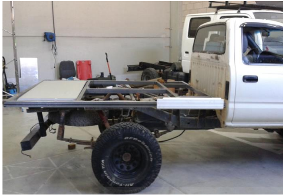
Figura 5. Estructura para la fijación de la base al chasis del vehículo e instalar sobre esta la célula vivienda.
