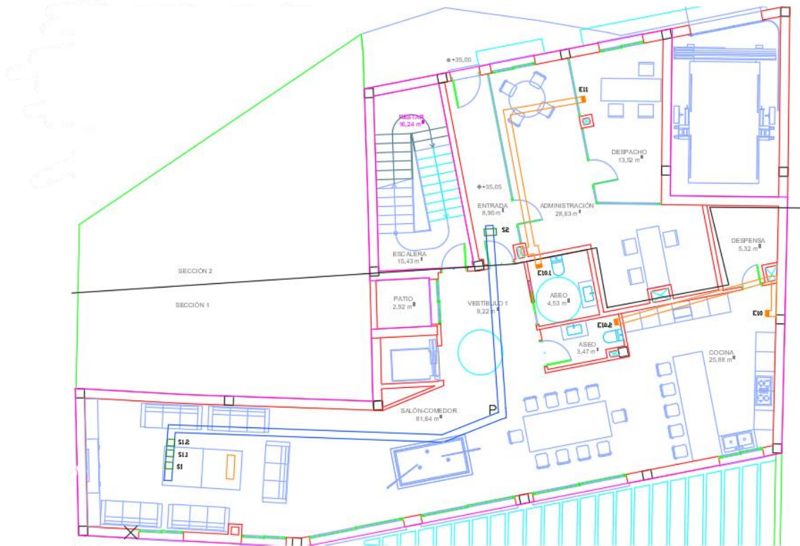
Ilustración 43 : : Configuración ventilación planta baja
