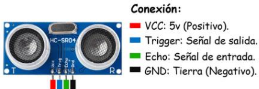
Imagen 6. Conexiones HC-SR04
