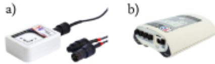
Figura 5. Sistema de captura de movimiento. (a) IMU (b) TechHub (Cárdenas & Molina, 2021)
