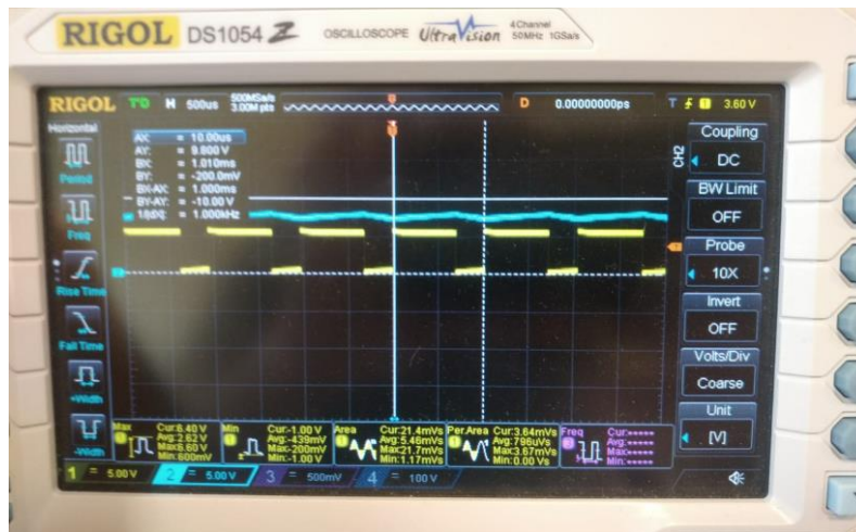
Figura 3.23: Entrada y salida del circuito de la figura 3.21 con un ciclo de trabajo del 70%
