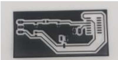
Figura 3.26: Pistas del circuito en papel de acetato
