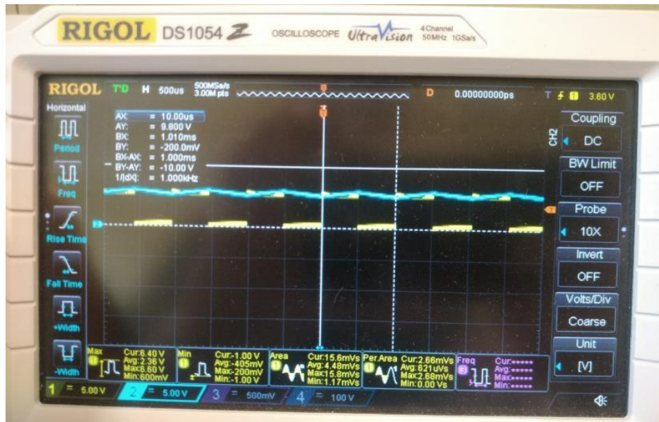
Figura 3.15: Captura del osciloscopio midiendo la salida del circuito de amplificación ajustada
